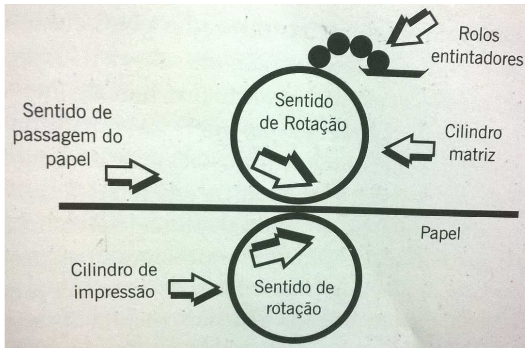
Figura 10 - Esquema da impressão flexográfica em papel
