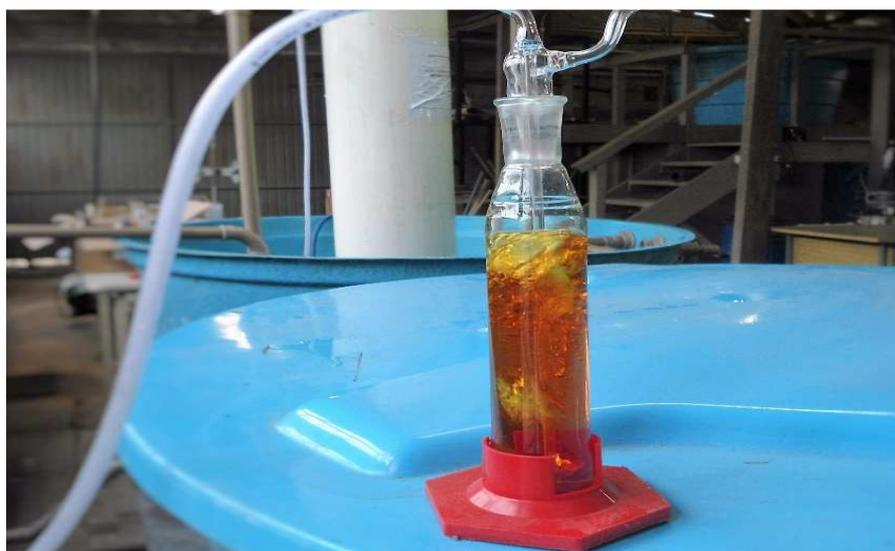
Na reação química do KI com o ozônio, há a quebra da molécula de ozônio transformando-a em oxigênio puro (O<sub>2</sub>) gerando iodo elementar, conforme a reação química apresentada pela Equação 2.
