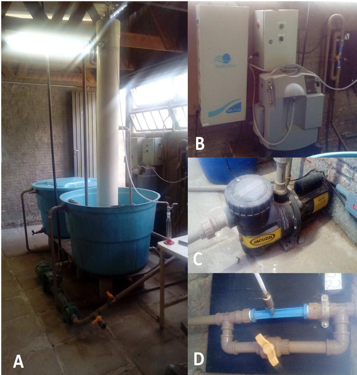
Legenda: A – Unidade de tratamento, reservatório e reator de PVC. B – Sistema de ozonização composto por um painel de controle, um concentrador de oxigênio e um gerador de  $O_3$ . C – Bomba centrífuga da marca Jacuzzi, para recirculação do efluente do reator para a unidade de ozonização/reator. D – Detalhe do tubo Venturi utilizado para injetar o  $O_3$  no efluente.
