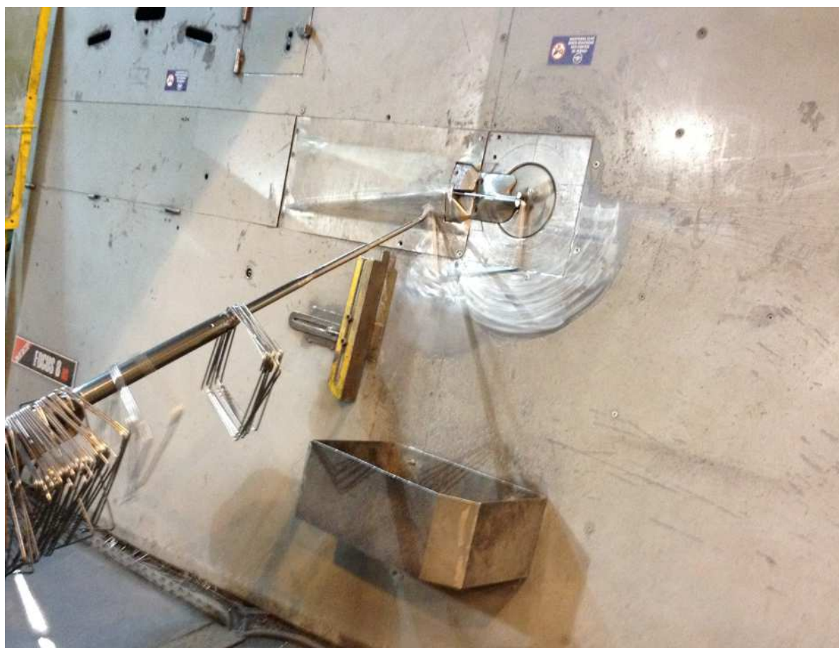
Figura 13 – Três fios sendo dobrados até que o estribo esteja pronto
