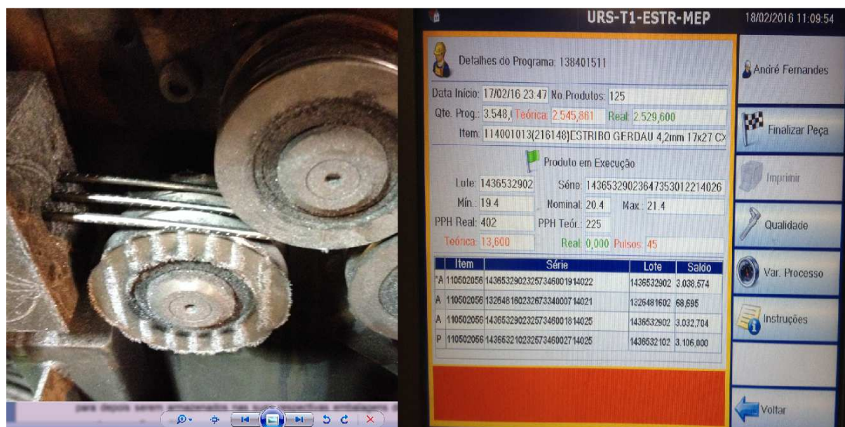
Figura 12 – Três fios de vergalhão nos roletes e programa de produção
