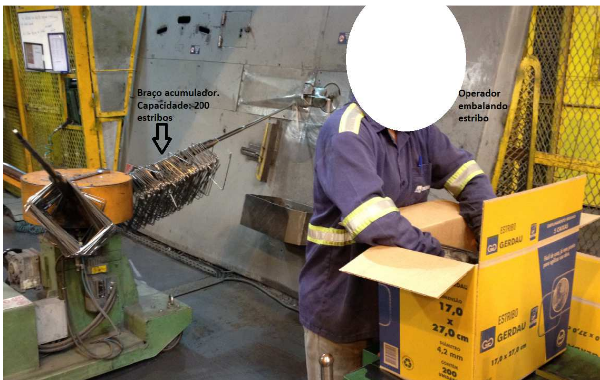
Figura 14 – Estribos sendo acumulados no braço e operador embalando as 200 unidades do que já está completo
