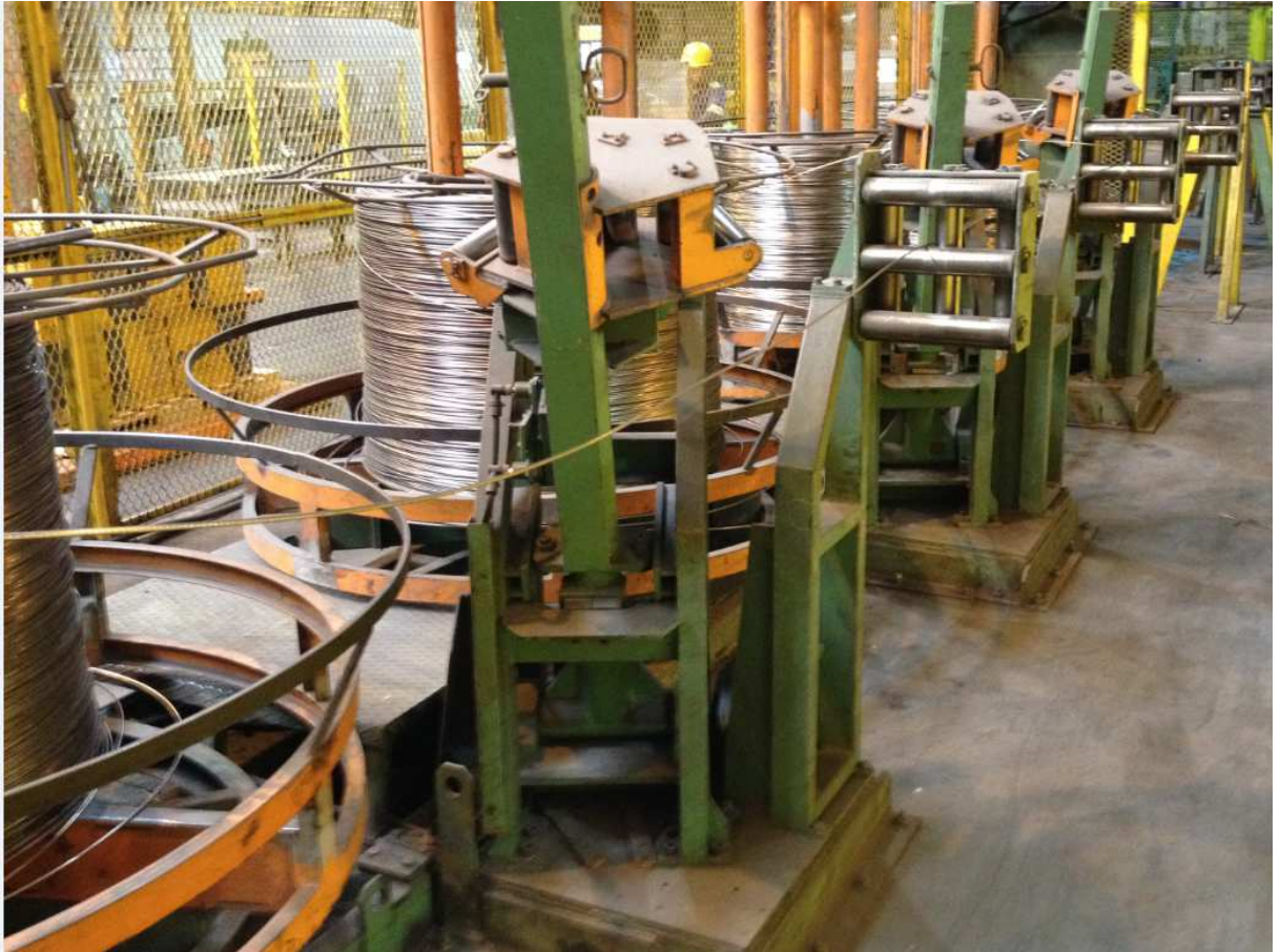
Figura 20 – Guias anti-enleio instaladas no pay-off
