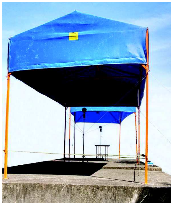
Figura 02: Disposição dos termômetros nas tendas com e sem proteção.
