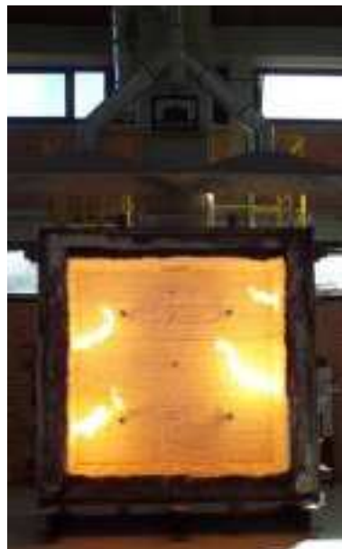
Figura 34 – Forno vertical com queimadores acesos.
