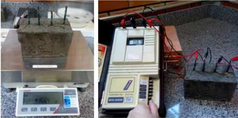
Figura 36 – Pesagem e leitura da resistividade.
