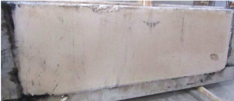
Figura 86 – Placa inferior – ensaio aos 56 dias de cura.
