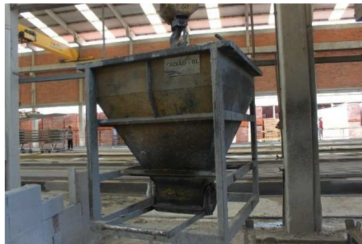
Figura 24 – Caçamba para transporte do concreto.
