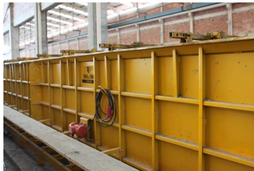
Figura 25 – Sistema de formas metálicas.
