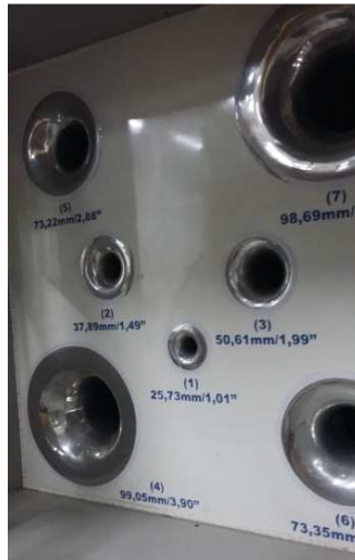
Figura 4.7: Placa de bocais do túnel do condensador.
