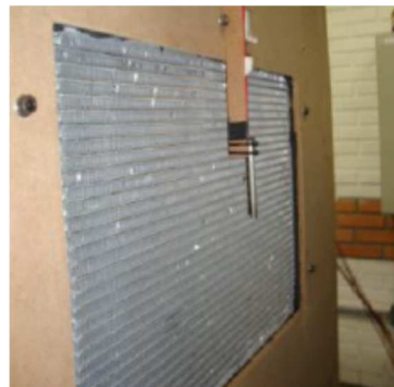
Figura 4.4: Localização do sensor PT 100 da temperatura de bulbo seco do ar na entrada do condensador.
