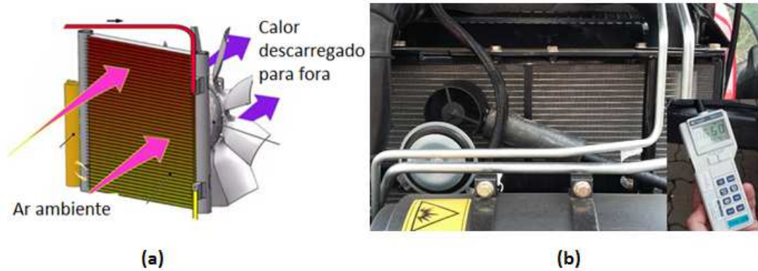
Figura 4.27: Instalação do condensador (a); Pontos de medição da velocidade de face do ar no condensador (b)
