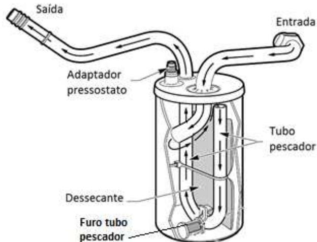
Figura 3.10: Esquema de funcionamento de um acumulador de sucção. Fonte: Adaptado de Red Dot Corporation (1993).
