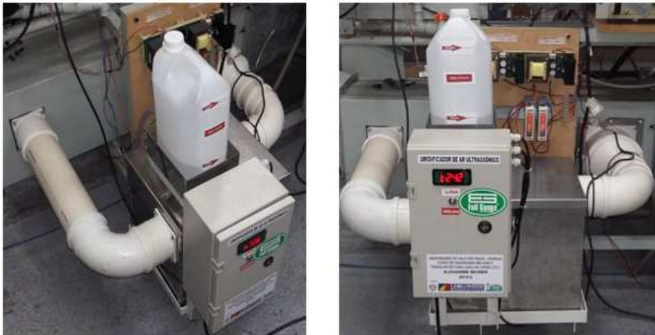
Figura 4.13: Sistema umidificador do calorímetro do evaporador.
