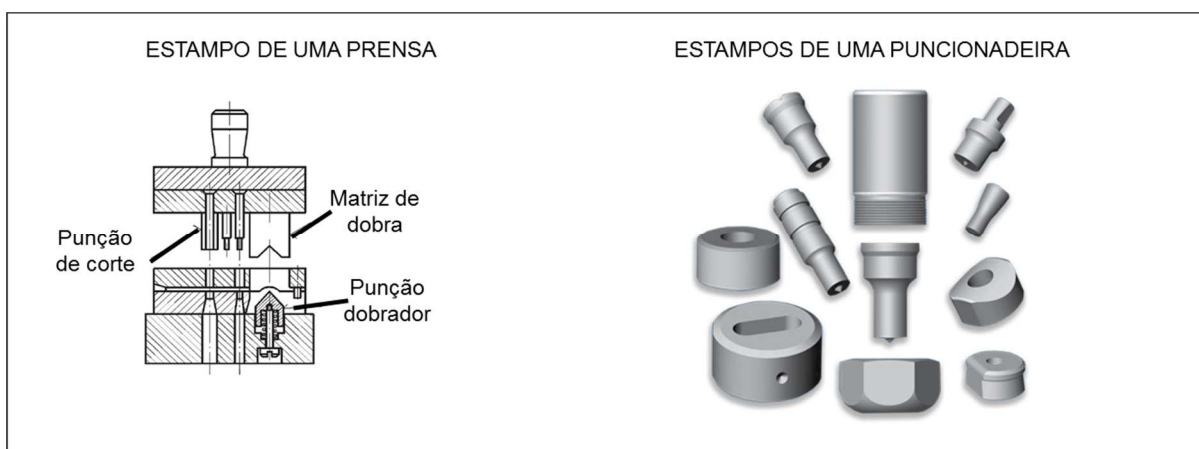
Figura 20: Estampo de uma prensa e ferramentas de uma puncioneira
