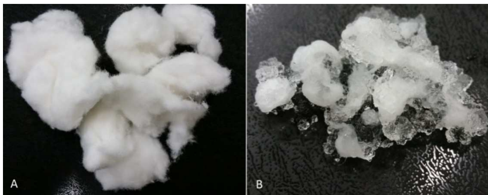
Figura 13 – FCPSA (foto A e B em proporções diferentes, não representam a mesma quantidade). a) FCPSA seco, assemelhando-se a um algodão; b) FCPSA com água incorporada, formando um gel.
