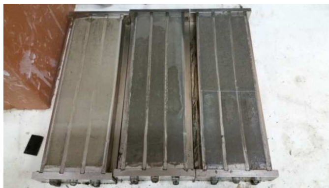
Figura 20 - Moldagem das barras destinadas ao ensaio de retração.
