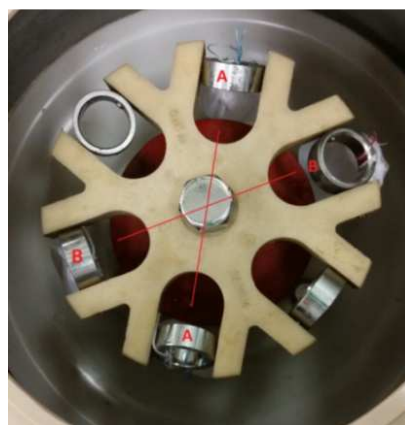
Figura 16 - Interior do equipamento centrifugador. A – filtros amarrados com FCPSA; B – filtros vazios.
