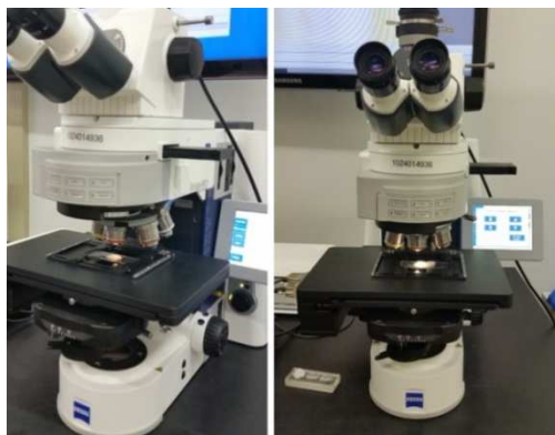
Figura 17 - Microscópio Axio Vision, modelo IMAGER M2m utilizado para o ensaio.
