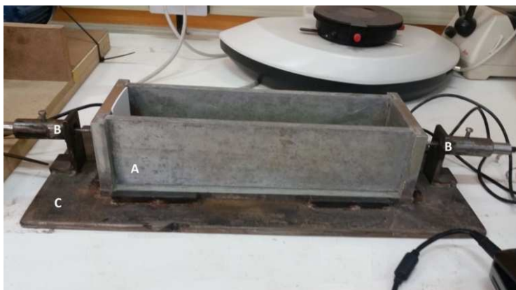
Figura 22 – Dispositivo de análise da retração plástica. A) Fôrma retangular com perfurações na lateral; B) Par de sensores LVDT; C) Base metálica.
