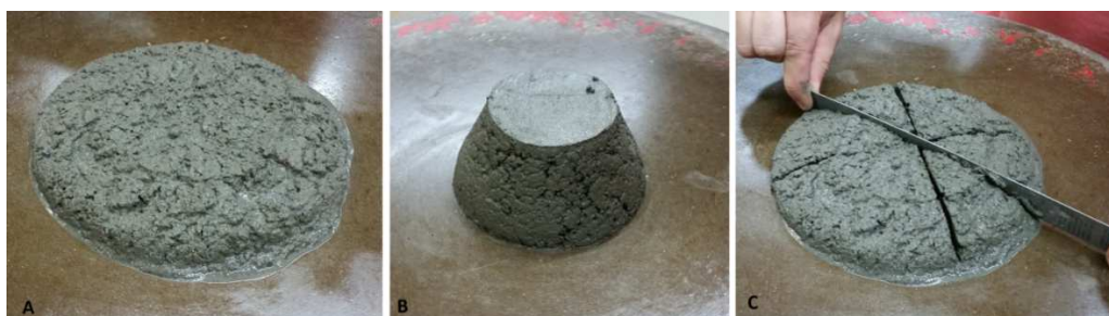
Figura 29 - Ensaio de consistência inicial com CP IV 32 com e sem FCPSA. a) Argamassa com FCPSA incorporada à mistura; b) Argamassa referência, sem a adição de FCPSA; c) Ajuste de consistência da argamassa referência com relação à consistência encontrada com a incorporação do FCPSA.
