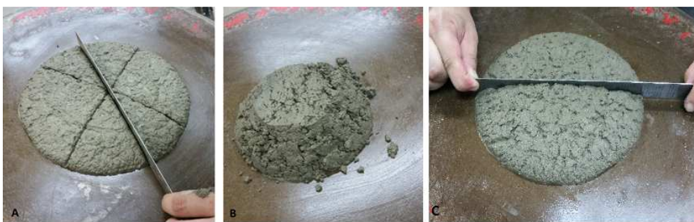
Figura 28 - Ensaio de consistência inicial com CP II-F 40 com e sem FCPSA. a) Argamassa com FCPSA incorporada à mistura; b) Argamassa referência, sem a adição de FCPSA; c) Ajuste de consistência da argamassa referência com relação à consistência encontrada com a incorporação do FCPSA.
