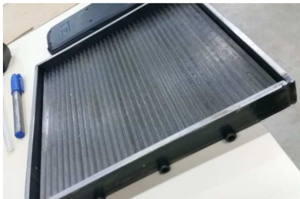
Figura 24 – Fôrma para análise da fissuração em estado fresco.
