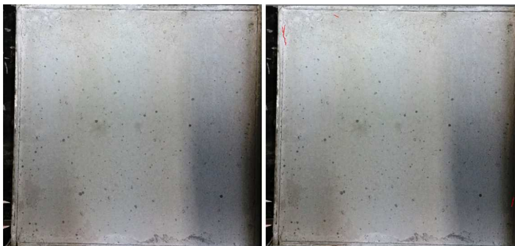
Figura 47 – Fissuração em estado fresco do CP IV 32 observada para a aragamassa FCPSA+; A) imagem coletada 24h após o início do ensaio; B) imagem analisada por meio de AutoCAD.
