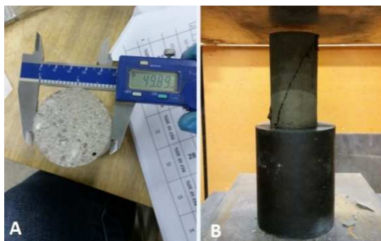
Figura 19 – Compressão das argamassas. A) Leituras das alturas e diâmetros do corpo de prova; B) Fim do ensaio de resistência à compressão, com ruptura do corpo de prova.
