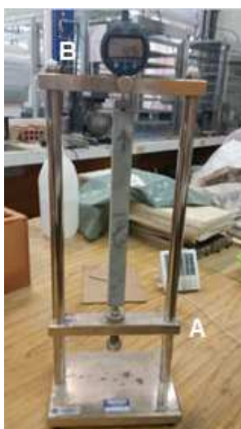
Figura 21 – Corpo de prova posicionado no equipamento para análise do ensaio de retração. (A- aparelho de retração; B – relógio comparador posicionado no topo do aparelho de retração)
