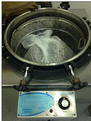
**Figura 22 – Autoclave da vermiculita.**
