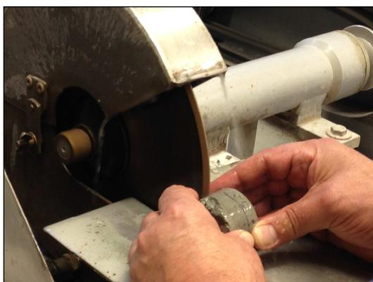
**Figura 18 – Corte dos corpos de prova.**
