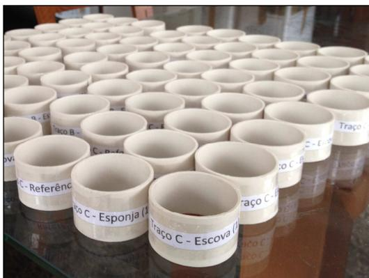
**Figura 13 – Formas dos corpos de prova.**
