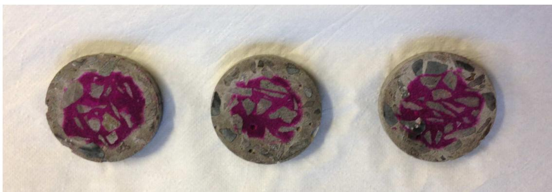
**Figura 32 – Medição da frente de carbonatação.**
