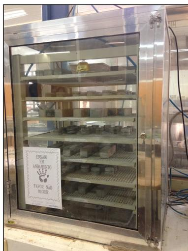
**Figura 17 – Câmara de carbonatação.**
