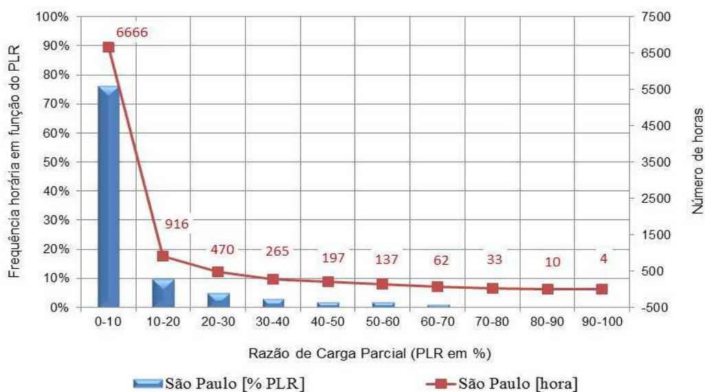
Figura B.1 - Frequência horária em função do PLR para localidade de São Paulo (SP)
