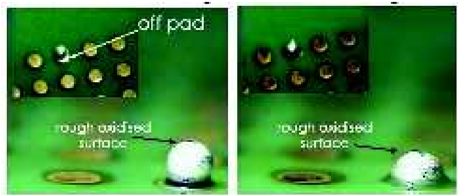
Figura 16 – Fluxo C com esferas oxidadas antes e depois do reflow.
