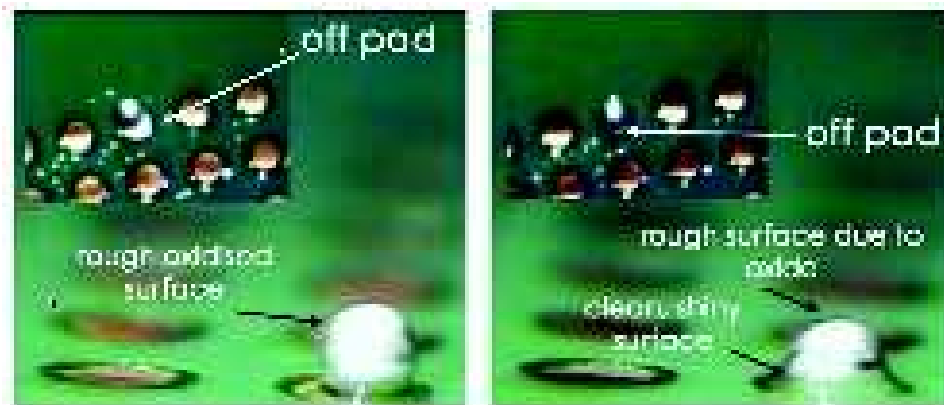
Figura 14 – Fluxo A com esferas oxidadas antes e depois do reflow.
