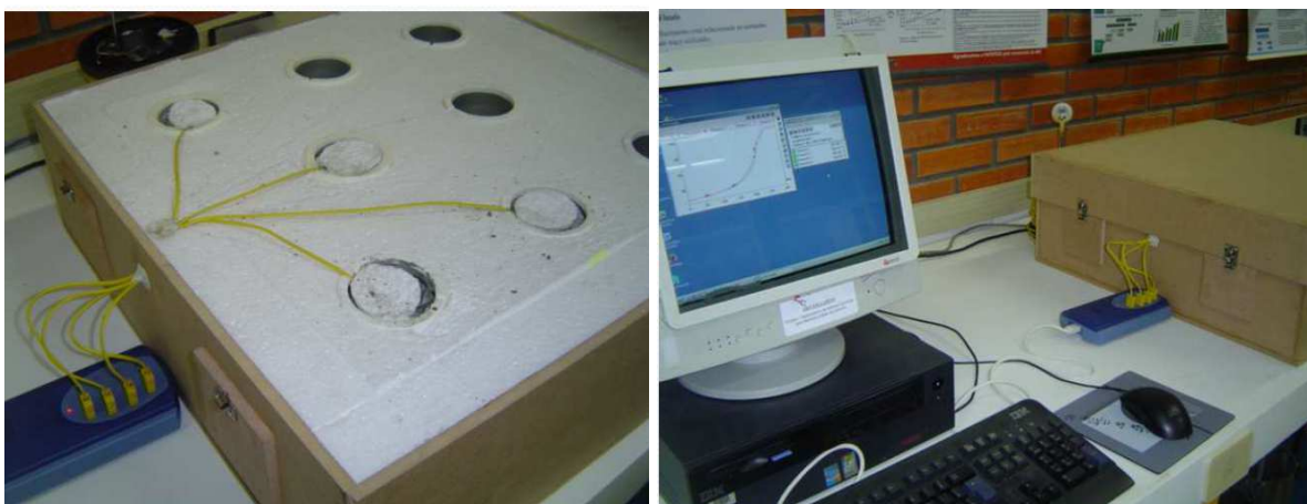
Figura 14 – Amostras na câmara semi-adiabática conectadas aos equipamentos de aquisição de dados.
