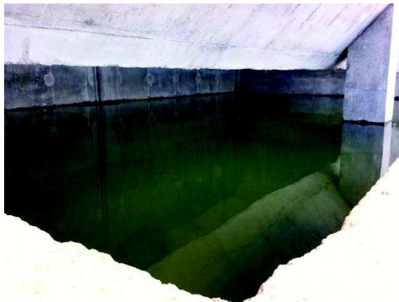
Figura 17 - Teste com carga d'água por 72h.
