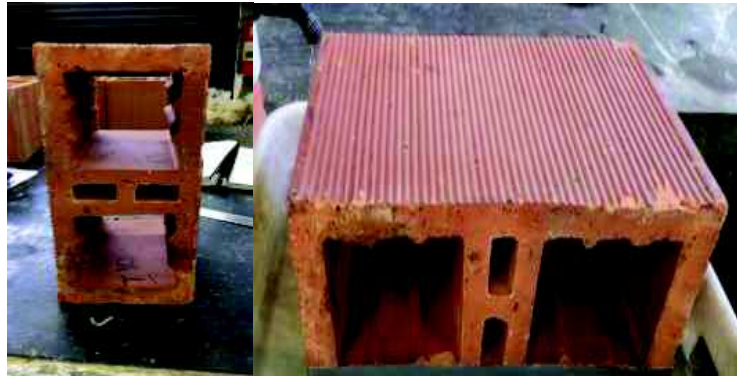
Figura 7 - Bloco cerâmico estrutural
