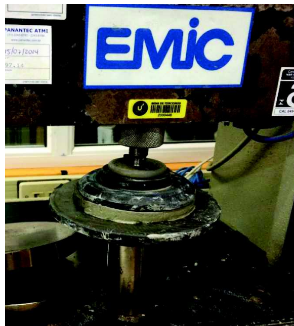
Figura 11 - Ensaio de Squeeze Flow para ajustes da trabalhabilidade das argamassas
