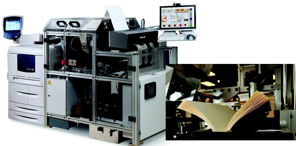
Figura 2: A Espresso Book Machine, uma das alternativas de impressão sob demanda (POD), executa todas as etapas de impressão e encadernamento de um livro. Fontes: docufacts.nl e AFP
