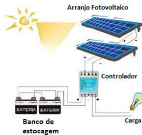
Figura 2.16: Representação esquemática de um SFI para uma carga alimentada com 12Vcc. Fonte: Adaptado de imagens do google
