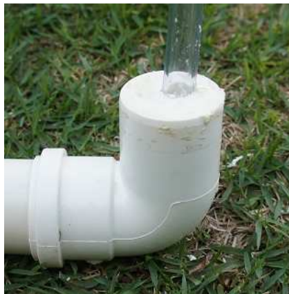
Figura 3.19: Detalhe mostrando o isolante térmico nas mangueiras
