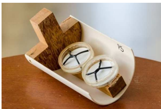
Figura 24 - Amostradores passivos de \text{SO}_2 utilizados nesta pesquisa
