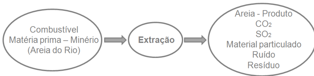
Figura 36 - Diagrama de blocos – Etapa de extração e beneficiamento do agregado natural – Areia
