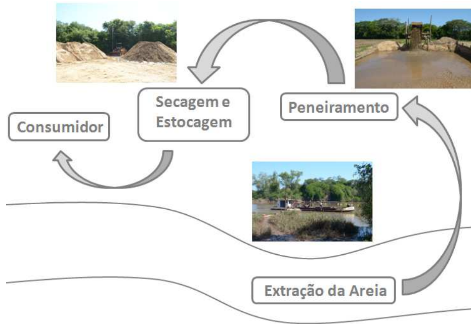
Figura 11 - Processos de extração e beneficiamento do agregado natural (areia)
