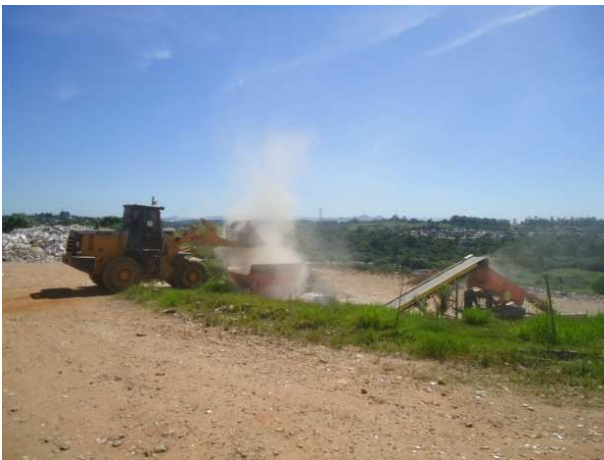
Figura 42 - Alimentação do britador para beneficiamento dos resíduos de construção e demolição
