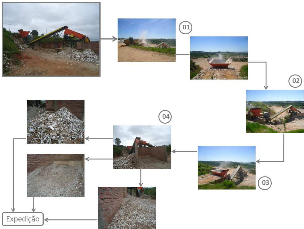
Figura 15- Detalhamento do processo de beneficiamento do agregado reciclado de resíduo de construção e demolição
