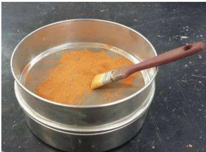
**Figura 24 - Peneiramento manual do RCV com auxílio de um pincel**
