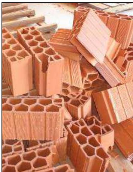
**Figura 19 - Peças avariadas após processo de sinterização**
