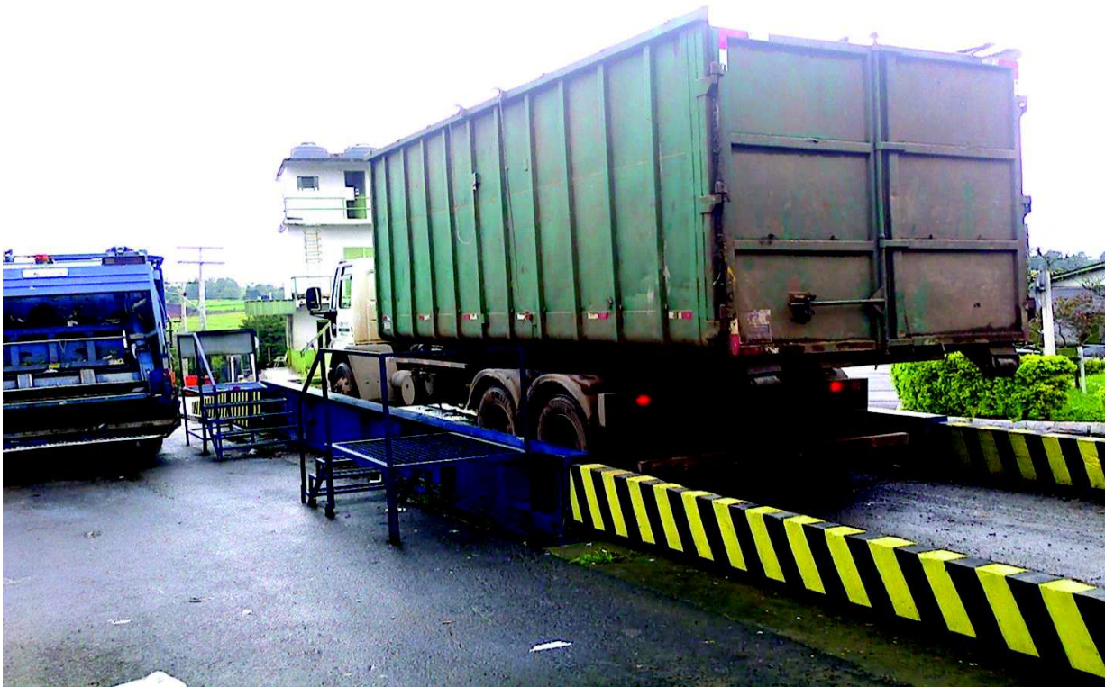
Figura 24 - Pesagem de caminhão com rejeitos
