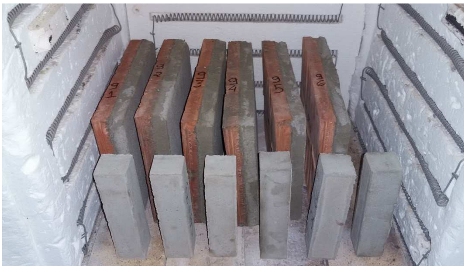
Figura 6 – Argamassas e placas revestidas posicionadas na mufla.
