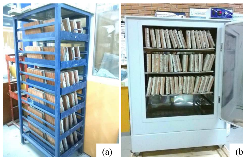
Figura 38 - Placas armazenadas em sala climatizada (a) e estufa de secagem (b)
