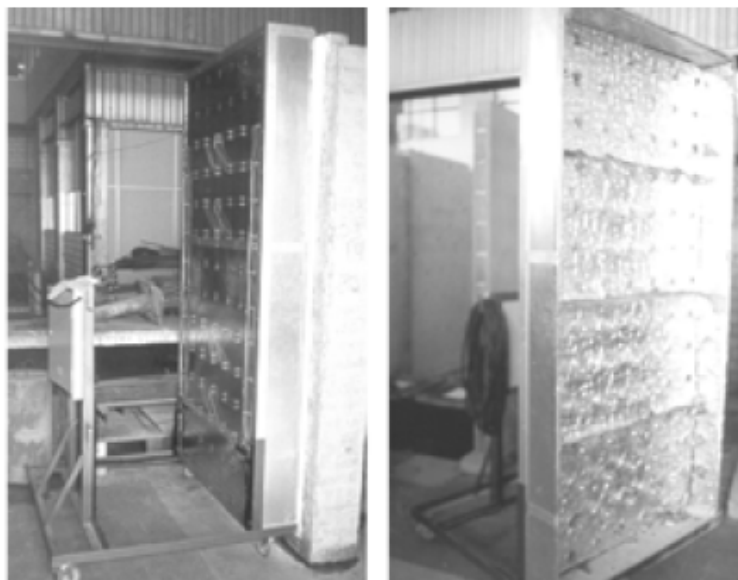
Figura 8 - Equipamento para ensaio de gradiente térmico do IPT (1998)
