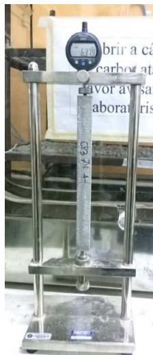
Figura 33 - Medição da variação dimensional por retração
