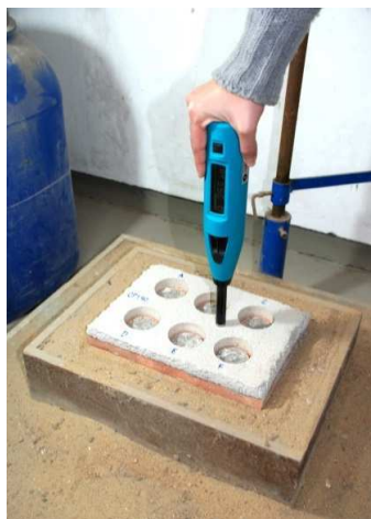
Figura 44 - Ensaio esclerométrico nos revestimentos
