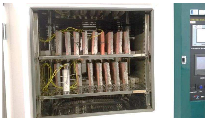
Figura 61 – Revestimentos argamassados acondicionados no interior da câmara
