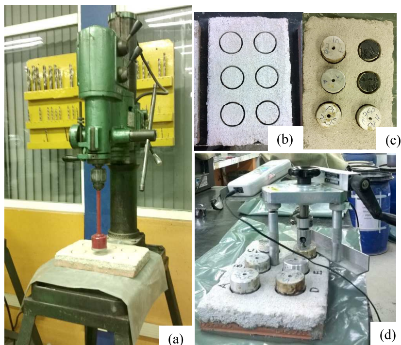
Figura 40 - Furadeira e serra copo (a), cortes no revestimento (b), cola e pastilhas aplicadas (c) e arrancamento (d)
