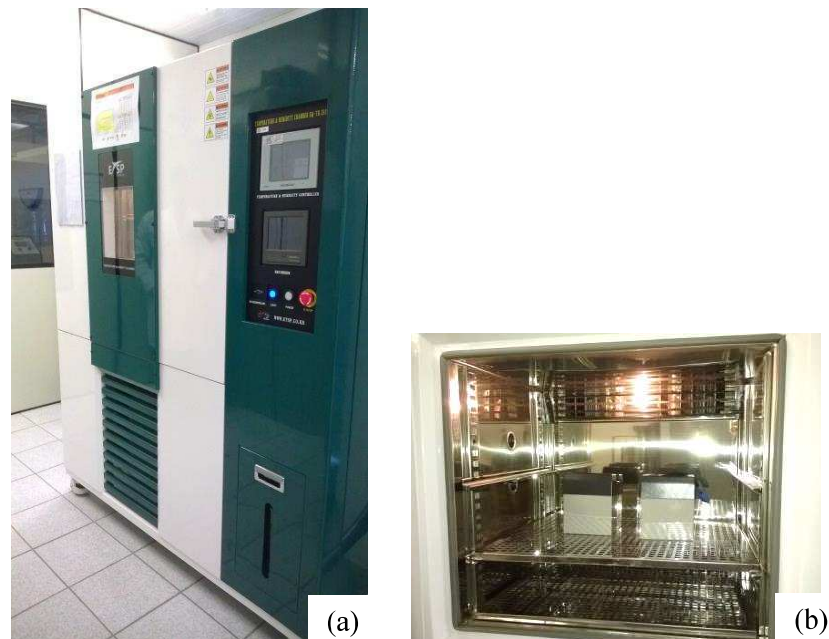
Figura 54 - Exterior da câmara climática (a) e interior da câmara (b)
