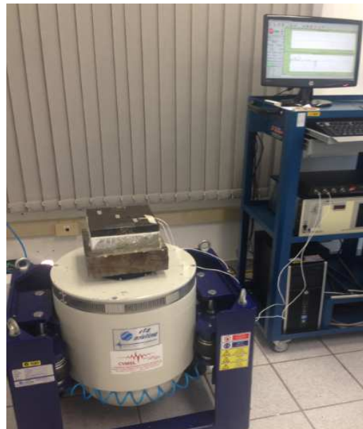
Figura 24: Procedimento de ensaio de rigidez dinâmica
