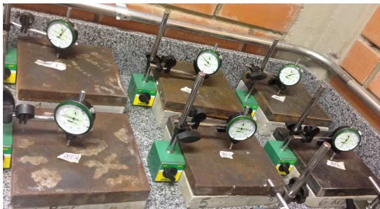
Figura 26: Esquema de ensaio de fluência à compressão
