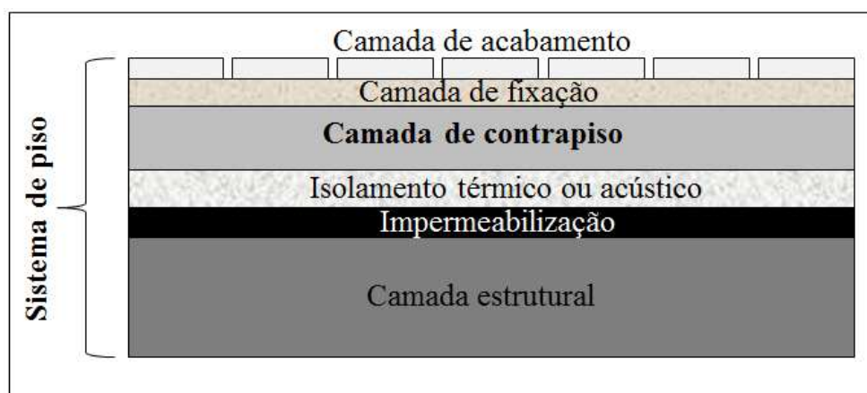
Figura 1: Exemplo de um sistema de piso
