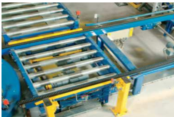
Figura 14 – Sistema de transporte por rolos e correntes
