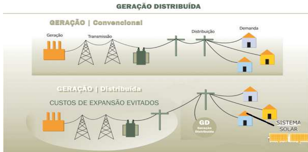
Figura 2.1 - Exemplificação de um sistema de geração distribuída com um ponto de conexão. Fonte: Adaptado pelo autor
