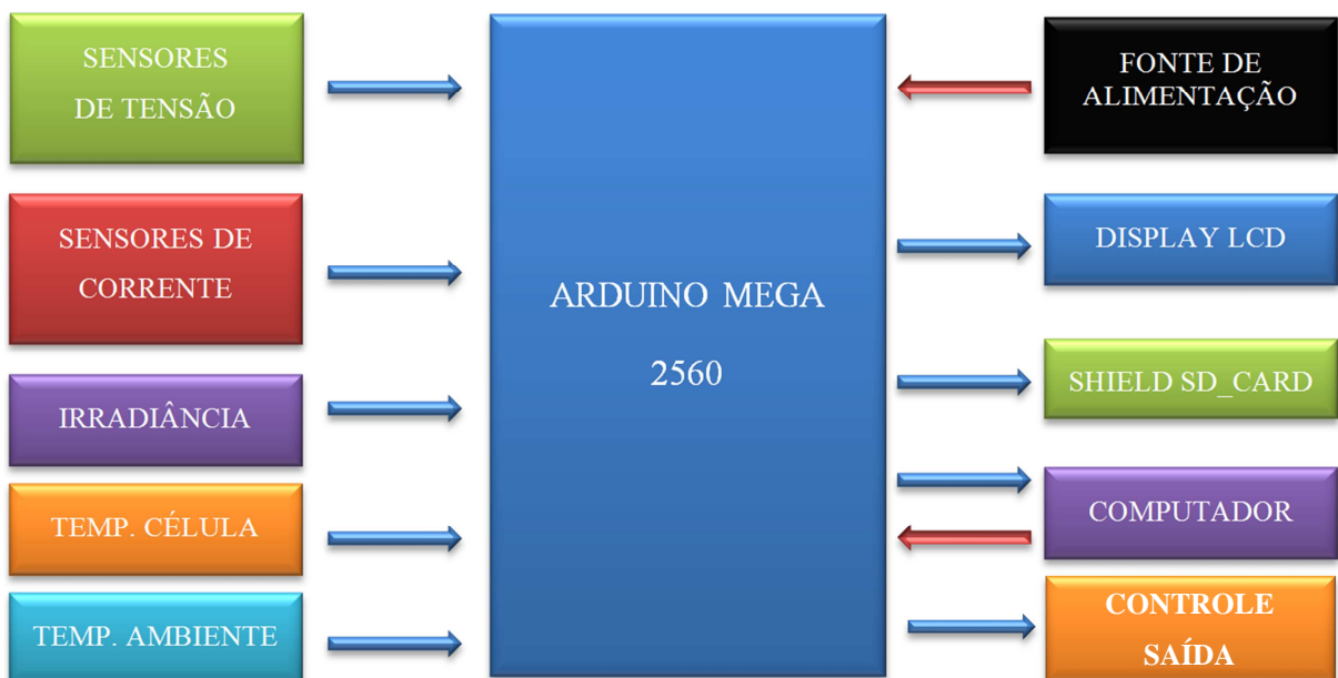
Figura 3.12 - Topologia utilizada para controle da microrrede.
