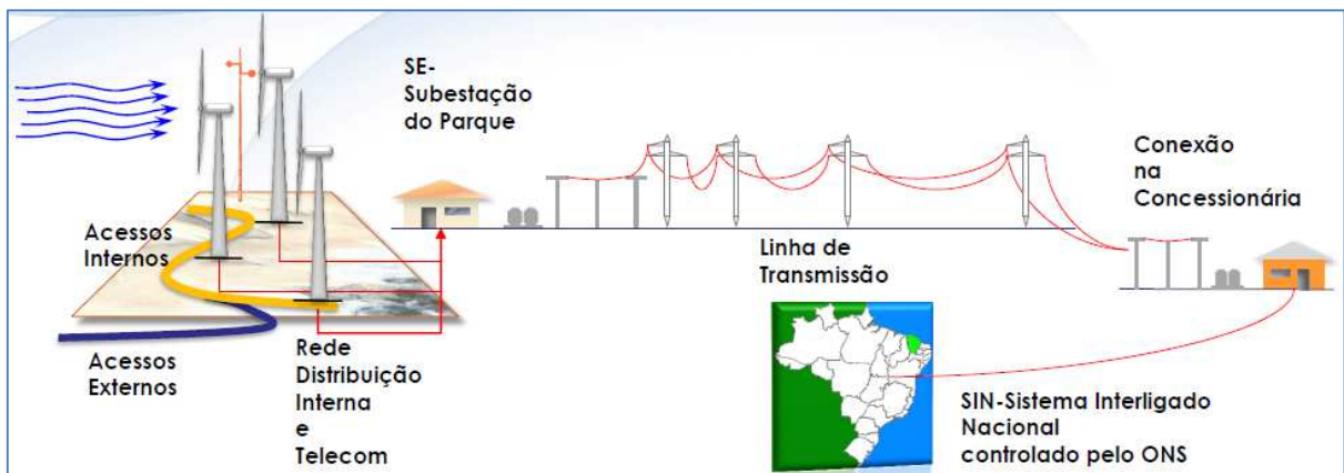
Figura 8 - Elementos que compõem um parque eólico
