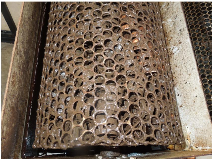
Figura 4- Biofilme formado no sistema CBR (primeiro estágio).
