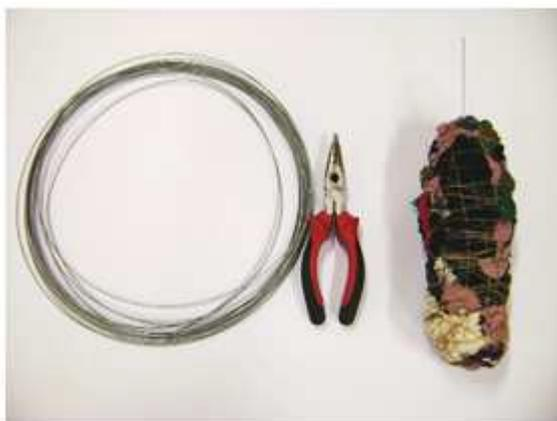
Figura 18: Molde de estopa e arame galvanizado.
