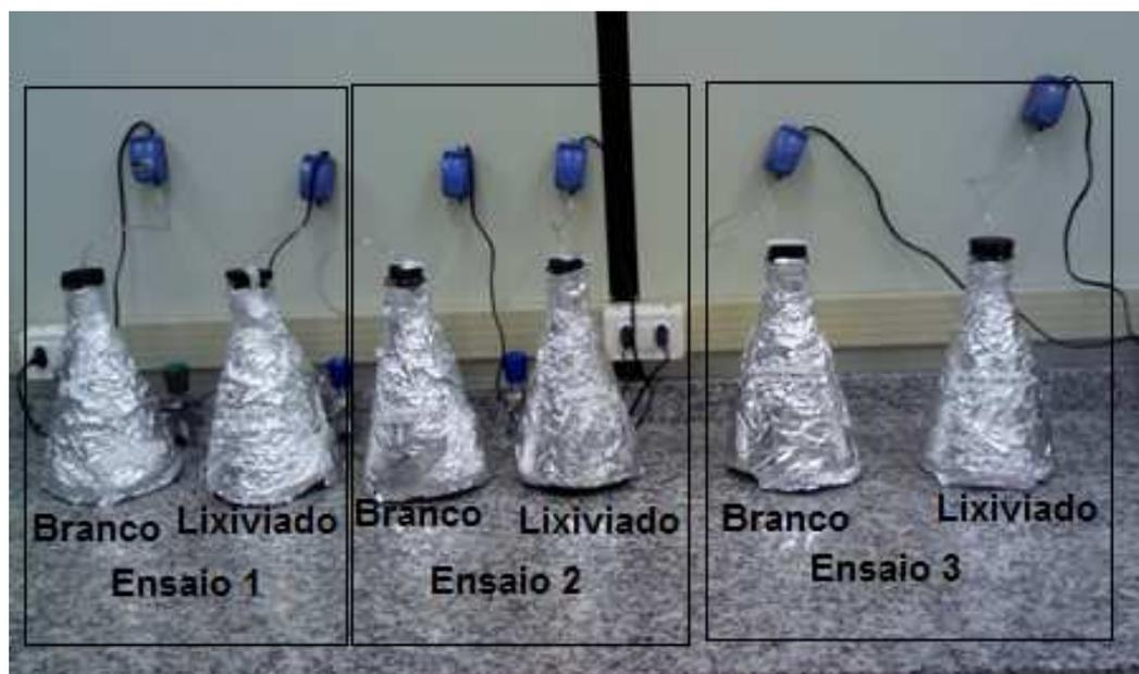
**Figura 11 - Reatores preparados para os ensaios de biodegradabilidade aeróbia**
