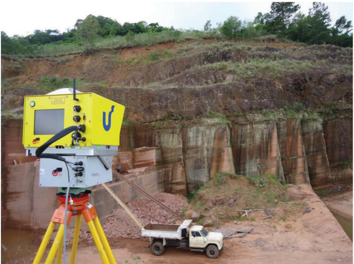
Figura 3: Laser Scanner Ilris 3D em operação em afloramento.
