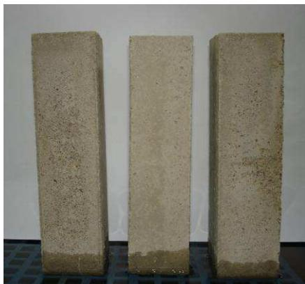
**Figura 24 - Absorção de água por capilaridade de argamassas.**
