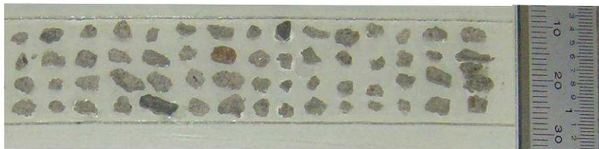
**Figura 30 - Amostra dos grãos do ARCT, retida na peneira de abertura 1,2mm.**
