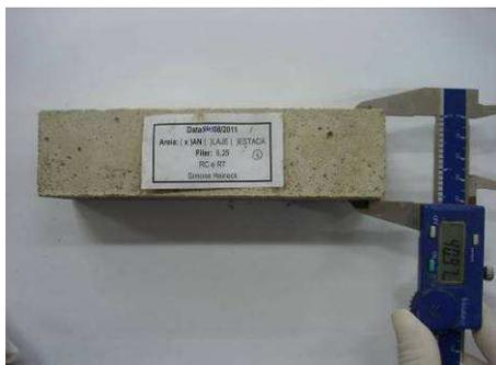
Figura 21 - Medição do CP para o ensaio de densidade de massa.
