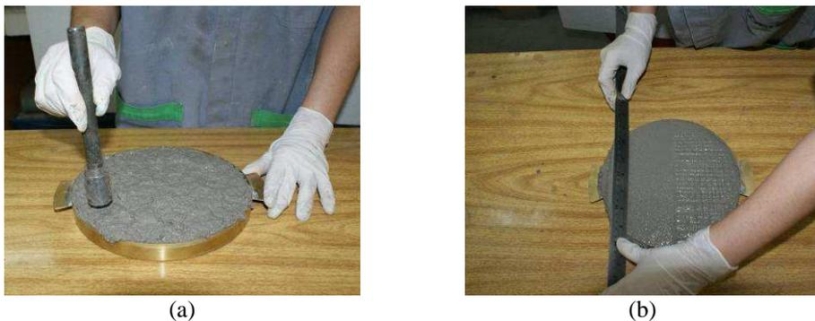
**Figura 18 – Procedimentos para o ensaio de retenção de água: (a) preparação da amostra através do adensamento da pasta com soquete; (b) rasamento com régua metálica.**
