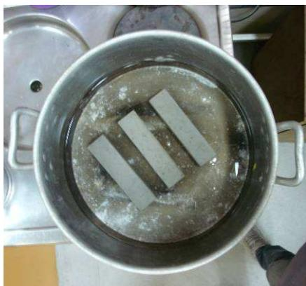
**Figura 25 - Absorção de água por imersão.**
