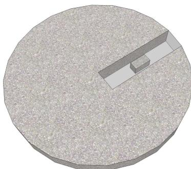
**Figura 27 - Posição da amostragem para o ensaio de determinação da distribuição de poros.**
