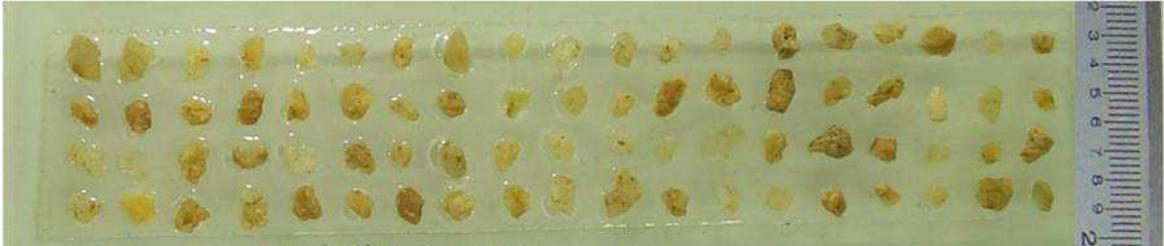
**Figura 5 - Amostra da AN, retida na peneira de abertura 1,2mm.**
