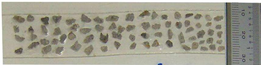
**Figura 29 - Amostra dos grãos do ARCC, retida na peneira de abertura 1,2mm.**
