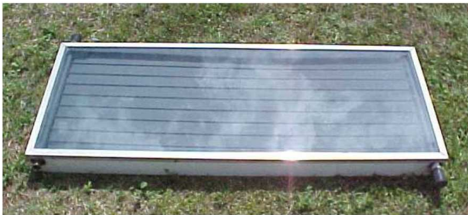
Figura 3.2: Coletor solar plano com cobertura Fonte: Costa, 2002
