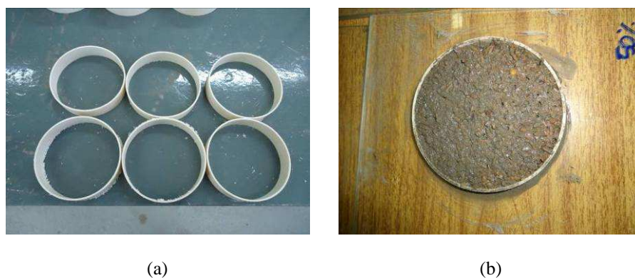
Figura 51: Moldagem dos CPs: (a) Moldes de PVC utilizados para a confecção dos CPs; (b) CPs de argamassa com laminas de vidro como base, com desmoldante a base de óleo
