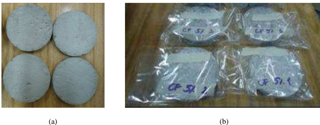
Figura 53: Configuração dos CPs: (a) CPs prontos para serem medidos; (b) CPs embalados individualmente em sacos plásticos para impedir absorção da umidade do ar
