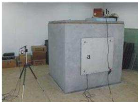
Figura 26: Conjunto de equipamentos de ensaio: (a) câmara acústica; (b) fonte de ruídos de impacto; (c) microfone.
