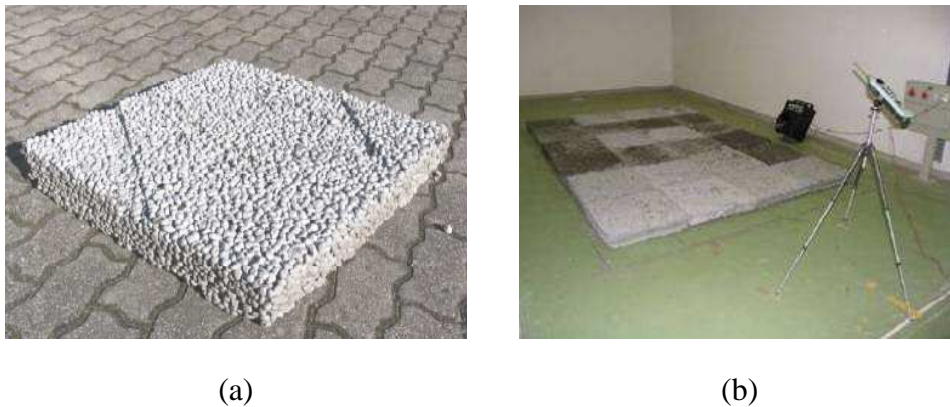
Figura 23: Câmara reverberante: (a) amostra; (b) medição do tempo de reverberação na posição da fonte e do sonômetro. Fonte: MAXIT (2011)
