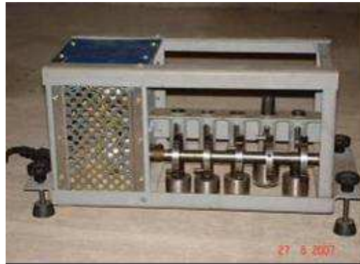
Figura 30: Máquina geradora de ruído de impacto – Padrão ISO 140-7 Fonte: Ferraz (2006)
