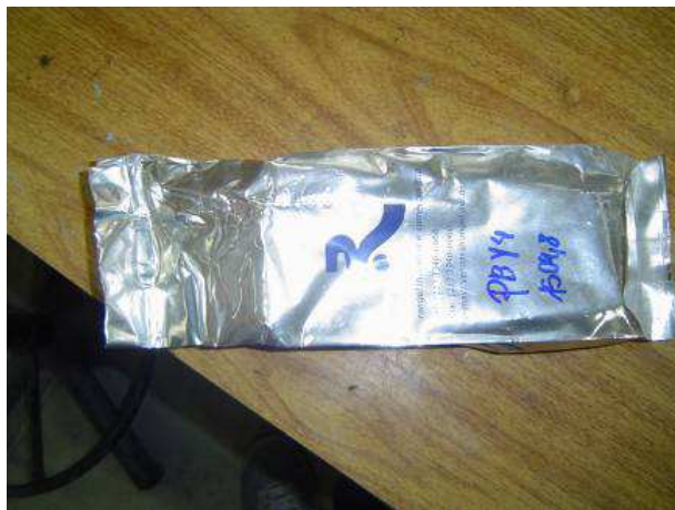
Figura 17 – Corpo de prova selado em embalagens impermeáveis com sua devida caracterização e peso.
