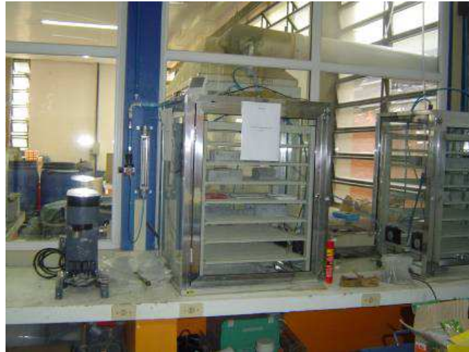
Figura 19 – Câmara de carbonatação utilizada para a carbonatação acelerada dos corpos de prova.
