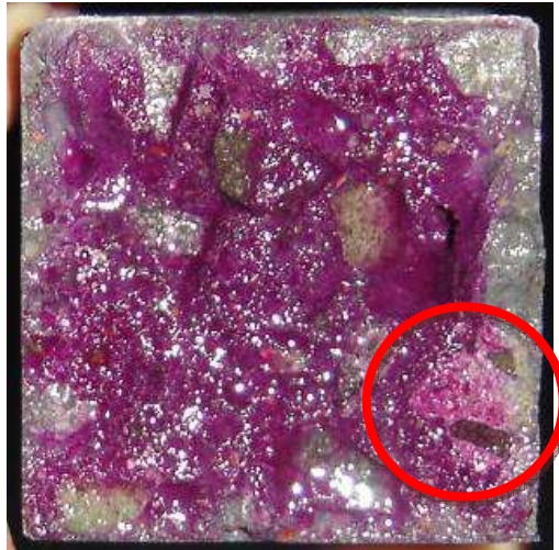
Figura 33 – Corpo de prova submetido a fenolftaleína após três dias de carbonatação acelerada.
