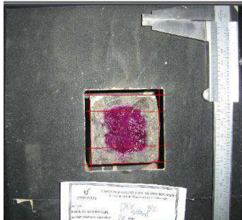
Figura 21 – Limitação da área de medição, no Software AutoCad, do fragmento de corpo após aspersão de fenolftaleína.
