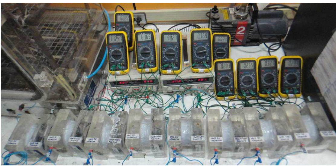
Figura 24 – Ensaio da ASTM C1202, com oito fatias sendo executado.
