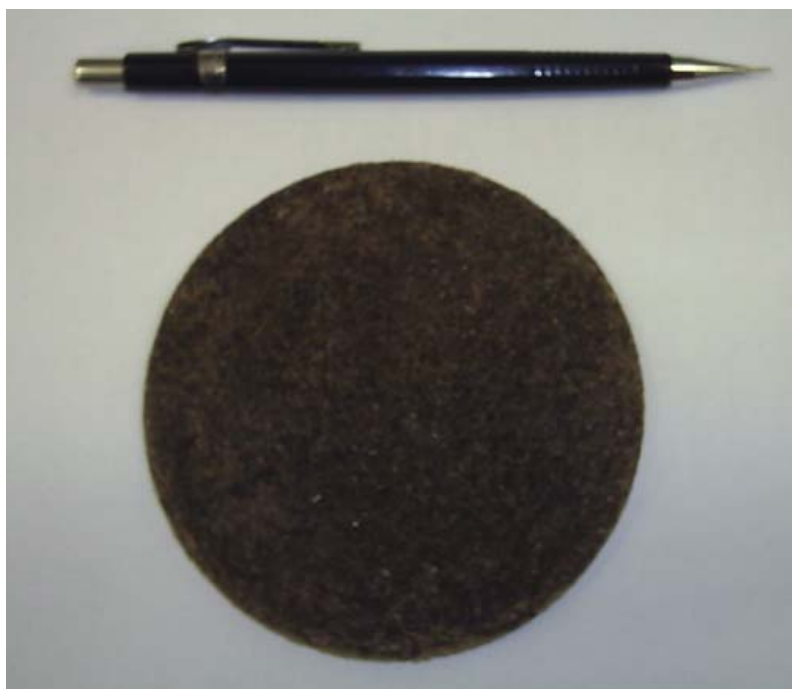
Figura 32: Pedra porosa depois da passagem do lixiviado
