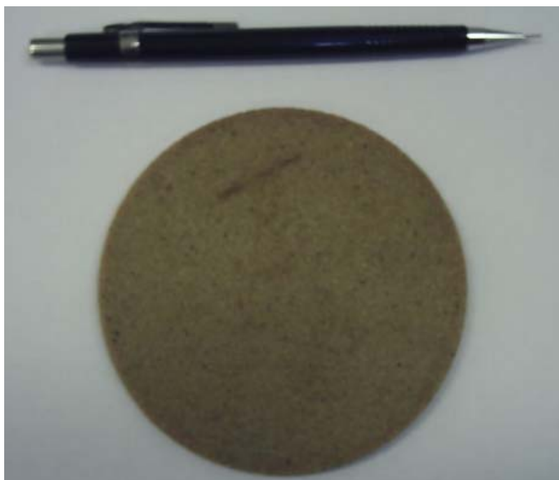
Figura 31: Pedra porosa antes da passagem do lixiviado
