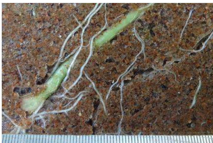
Figura 51 – Detalhe da formação de interstícios entre raízes e areia.
