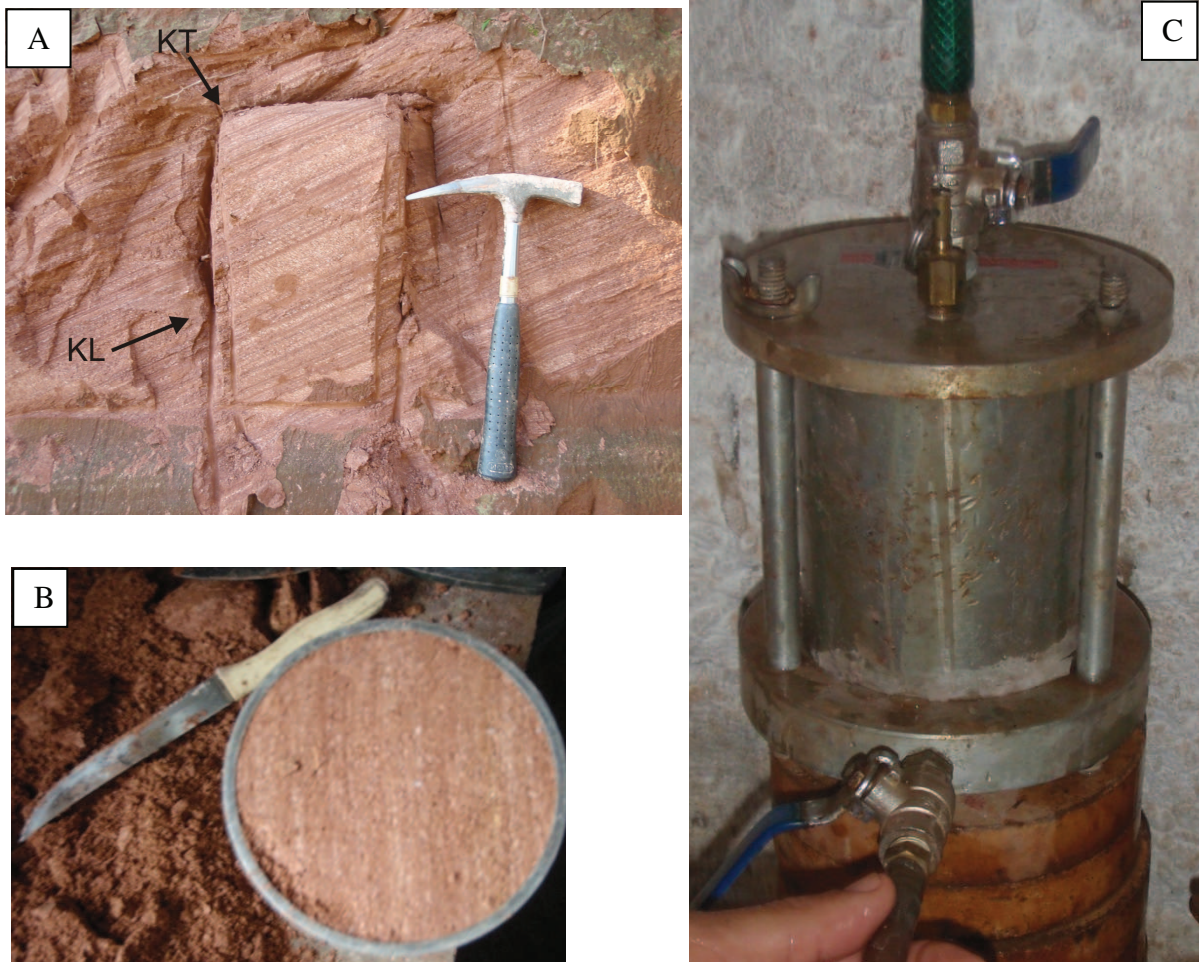
Figura 16 – (A) Coleta de amostra deformada em afloramento. (B) Amostra sendo preparada para o ensaio de permeabilidade em laboratório no sentido longitudinal. (C) Permeâmetro com parede rígida.
