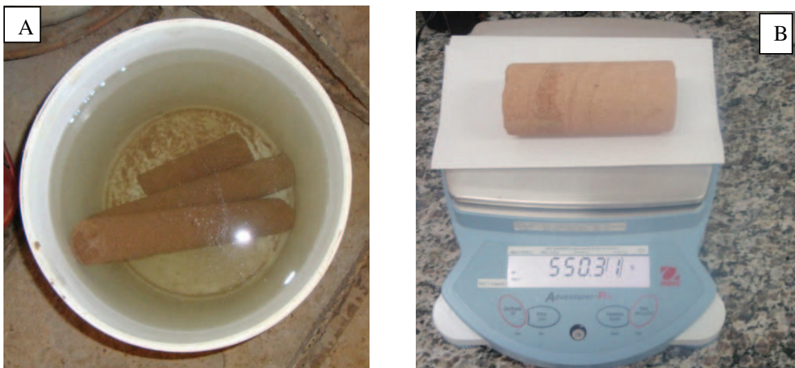
Figura 15 – (A) Amostra imersa na água. (B) Amostra sendo pesada para determinação do seu peso seco.
