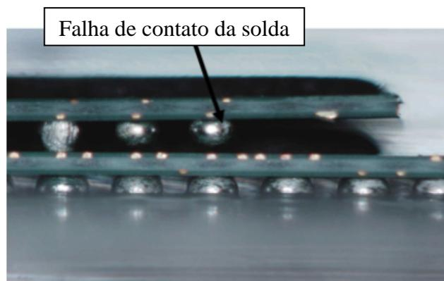
Figura 2.11 – Detalhe de soldas rompidas na junção do encapsulamento PoP devido ao empenamento ocorrido no processo de refusão.
