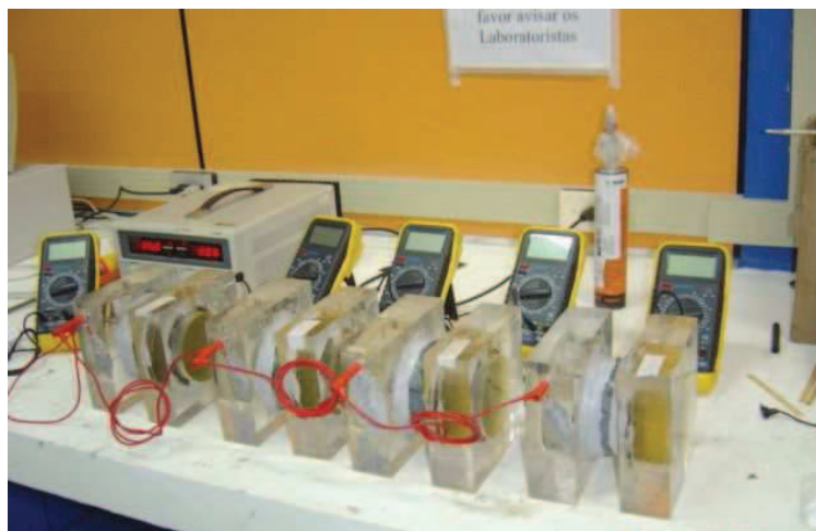
Figura 26 - Esquema da montagem do ensaio de penetração de cloretos
