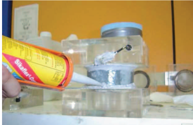
Figura 25 – Colagem dos corpos de prova às células de acrílico
