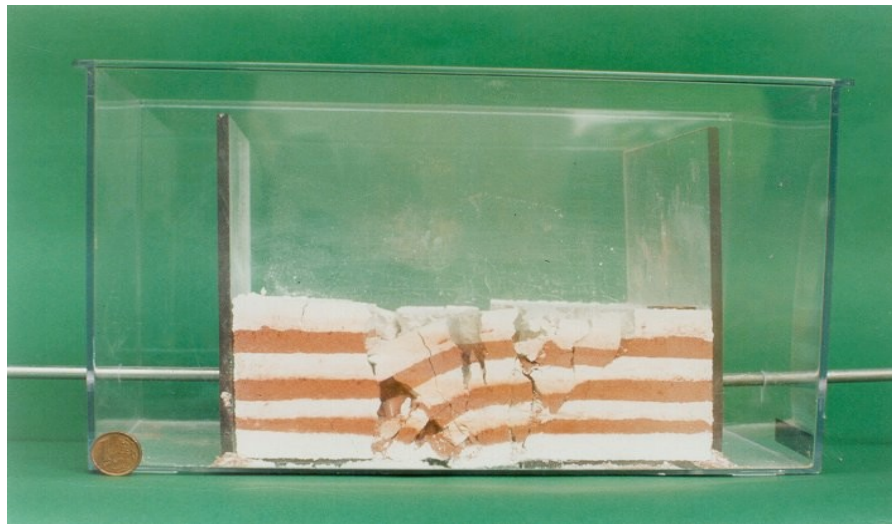
Figura 6.5 - Extensão = 25 % Abatimento de blocos e roll over (segundo Martins et al. 2000).
