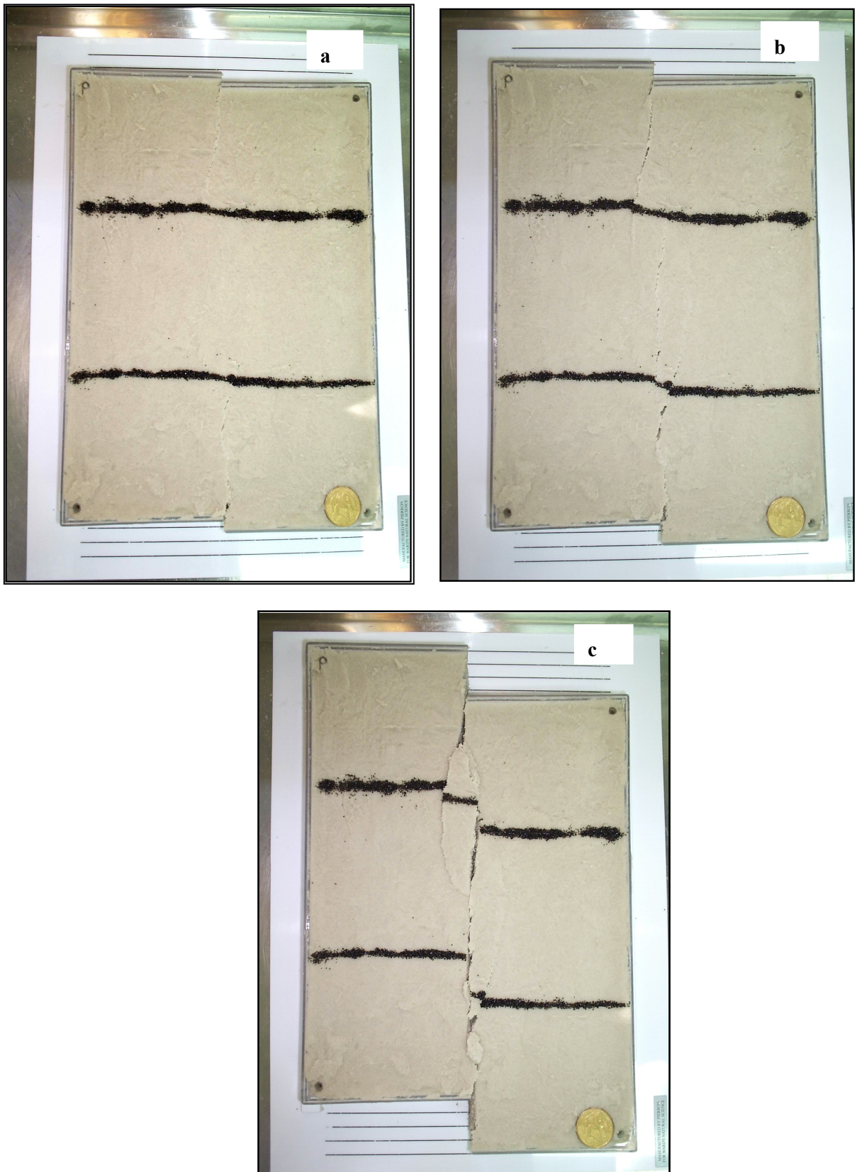
Figura 6.1 – Seqüência de formação de estruturas ligadas a falha transcorrente. a) falhas escalonadas; b) duplex transpressivo; c) estrutura em flor; seta indica dobra.
