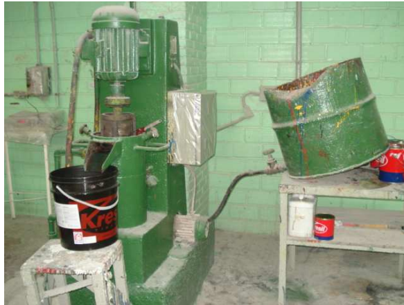
Figura 3. Moinho, utilizado para moer cargas e pigmentos.
