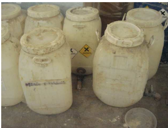
Figura 41 - Armazenamento inadequado de produtos químicos.
