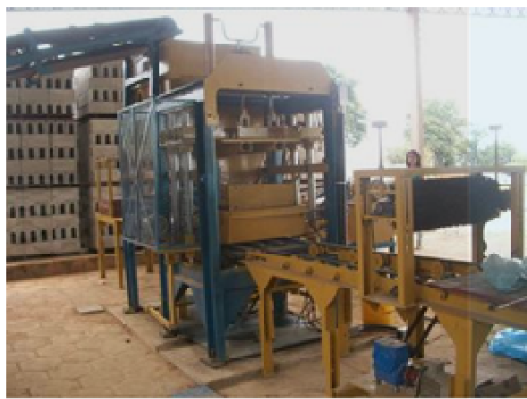
Figura 3 - Vibro-prensa utilizados na produção dos blocos de concreto para pavimentação.
