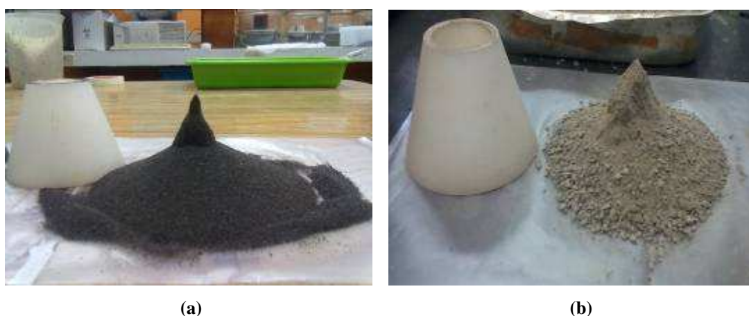
Figura 7 - Preparação dos resíduos de fundição (a) e o agregado AI (b) para o ensaio de massa específica.
