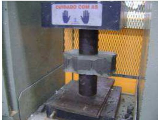
Figura 14 - Ensaio de rompimento dos blocos para medir a resistência mecânica à compressão.
