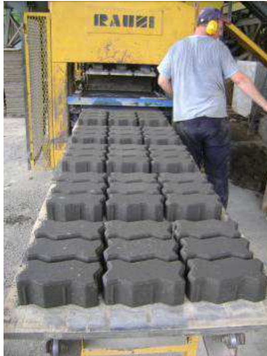
Figura 9 - Desmoldagem dos blocos de concreto após a vibro-prensagem.
