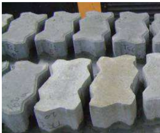
Figura 13 - Capeamento dos blocos para ensaio de resistência à compressão.
