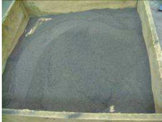
Figura 8 - Co-produto formado pelo empacotamento dos resíduos de fundição AFUV e AVUF.
