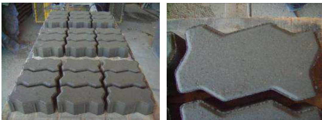
Figura 10 - Blocos de concreto para pavimentação produzidos com 25% de substituição da AN pela combinação da AFUF e AVUF.
