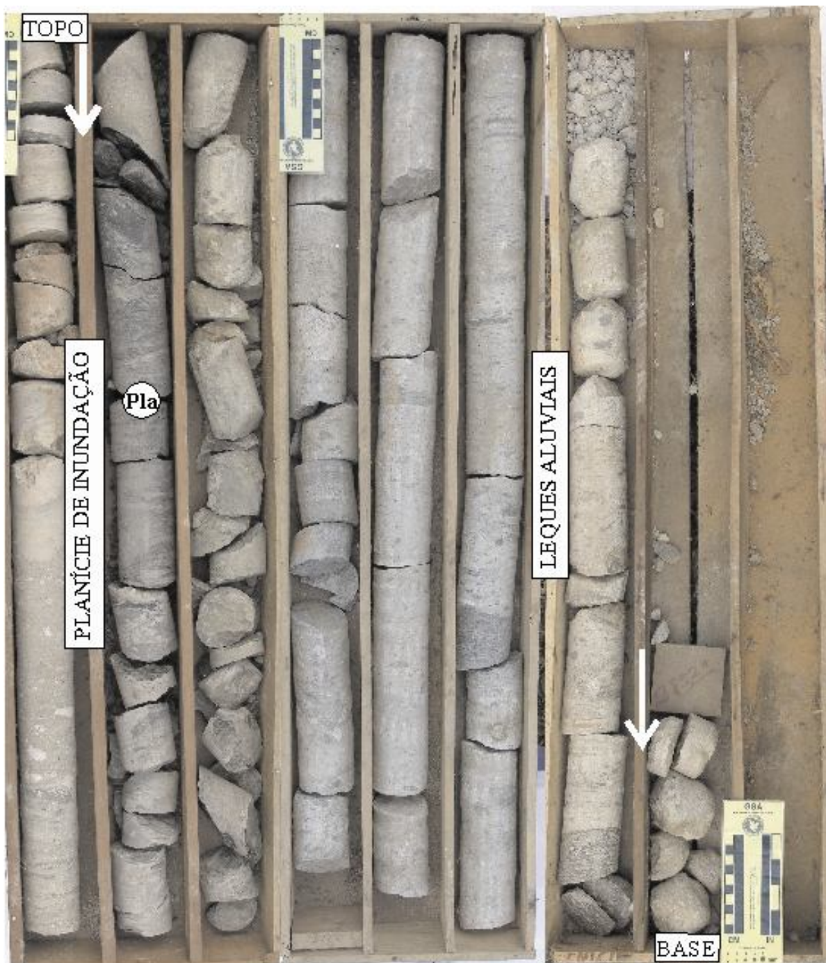
Figura 5: Fácies de leques aluviais (Pg) intercalados a fácies de planície de inundação (SiltArg) no testemunho de sondagem IB-04-RS (profundidade entre 285,20 e 277,00 m). Icnofábrica simples de Planolites (BI 1-2) na fácies de planície de inundação (SiltArg), profundidade entre 278,30 e 277,50 m. Escala: 10 cm.
