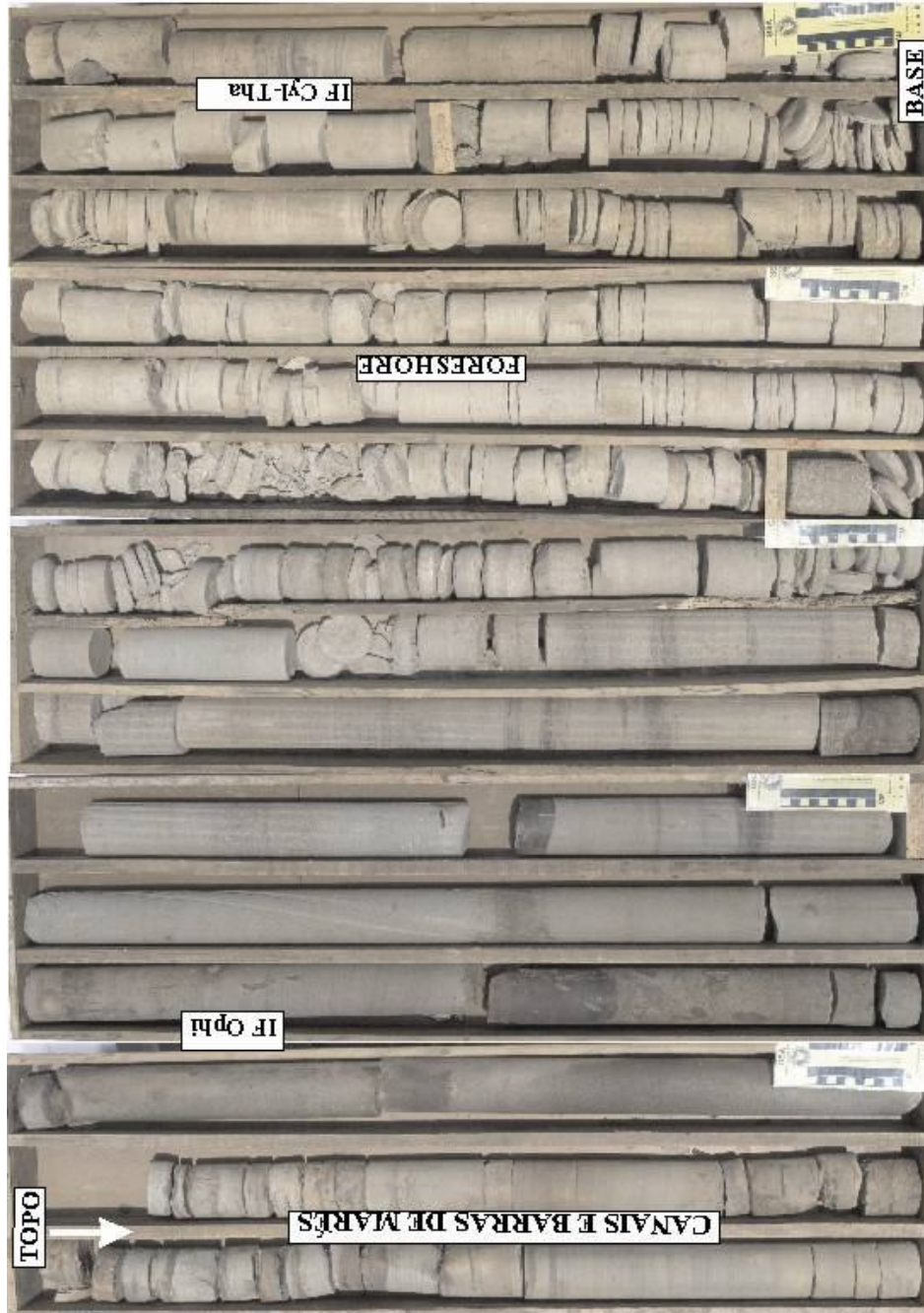
Figura 8. Fácies de canais e barras de mares (litofácies Aq2), contendo a icnofábrica de Ophiomorpha , e fácies de foreshore , contendo a icnofábrica de Cylindrichnus-Thalassinoides . Testemunho de sondagem IB-15-RS, profundidade entre 287,00 e 273,00 m. Escala 10 cm.
