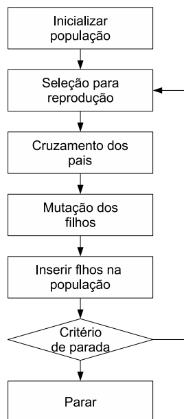
Figura 29: Fluxograma de uma algoritmo genético básico, como implementado pela GAlib .
