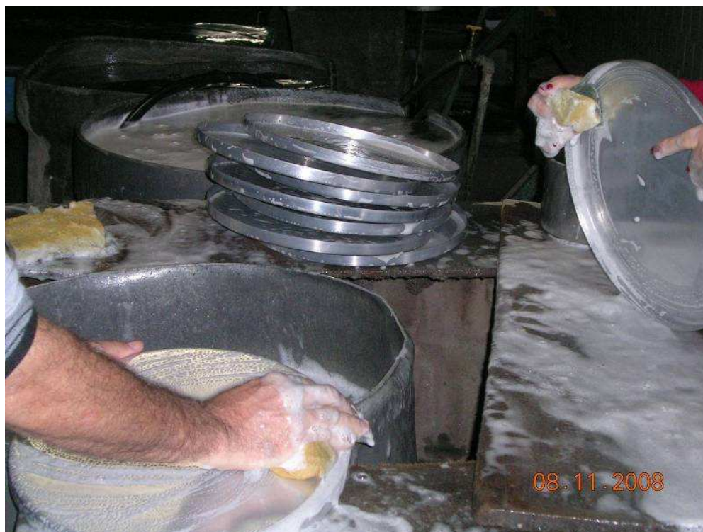
Figura 10. Lavagem dos Produtos Antes de Irem para o Forno de Secagem
