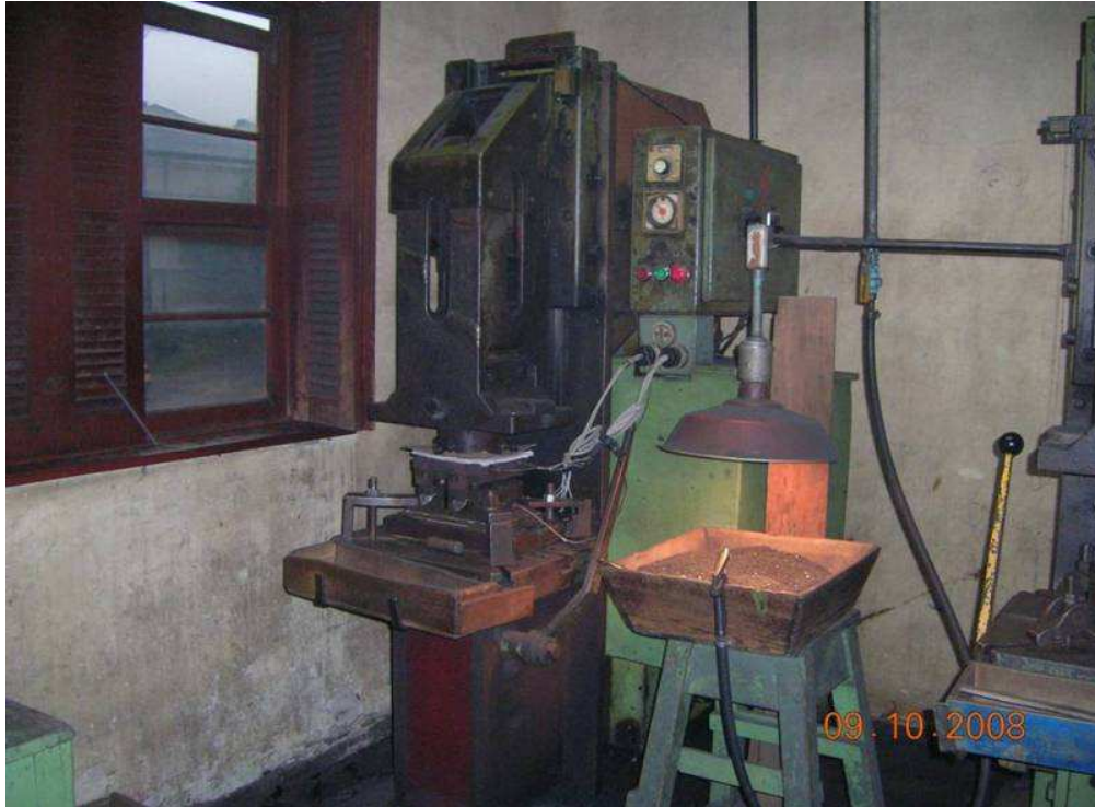
Figura 7. Máquina que Produz Peças em Baquelite
