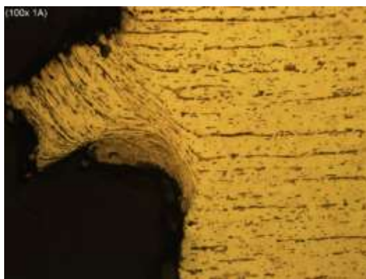
Figura 38 – Amostra 1A, Aço 1141, f_n=0,05 , v_c=100\text{m/min} , geometria PR, 100x.
