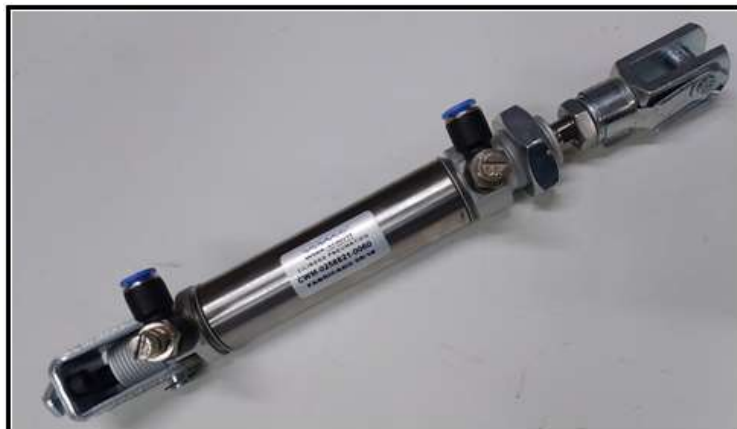
Figura 29 – Atuador pneumático para acionar o dispositivo
