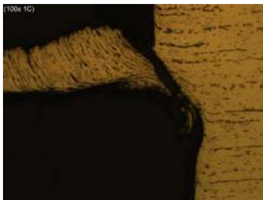
Figura 40 – Amostra 1C, Aço 1141, f_n=0,20 , v_c=100\text{m/min} , geometria PR, 100x.
