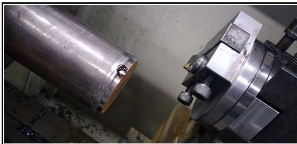
Figura 31 – Dispositivo desarmado e cavaco fixo na peça
