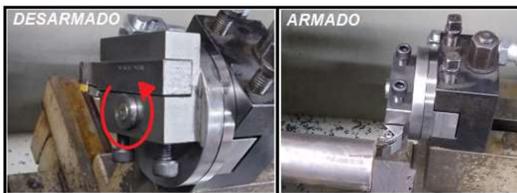
Figura 32 – Movimento para rearmar o dispositivo
