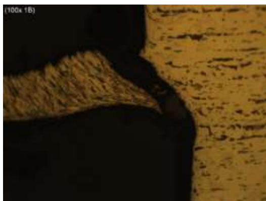
Figura 39 – Amostra 1B, Aço 1141, f_n=0,10 , v_c=100\text{m/min} , geometria PR, 100x.
