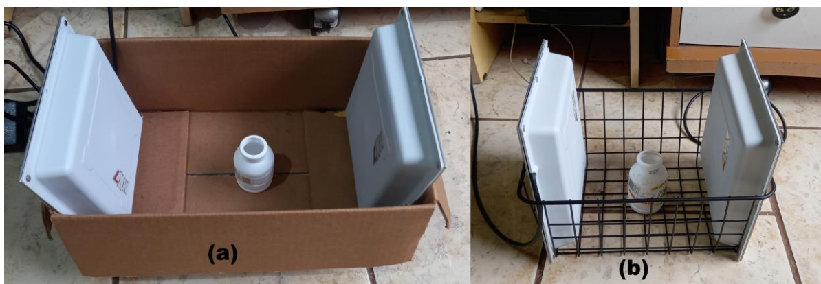
Figura 18 – Teste do produto dentro da área a ser lido (a) caixa de papelão (b) cesto metálico
