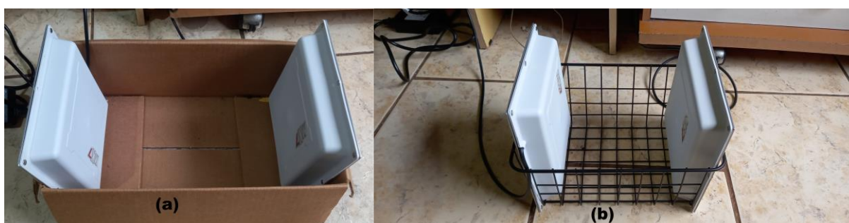
Figura 17 – Disposição das antenas RFID no protótipo (a) caixa de papelão (b) cesto metálico
