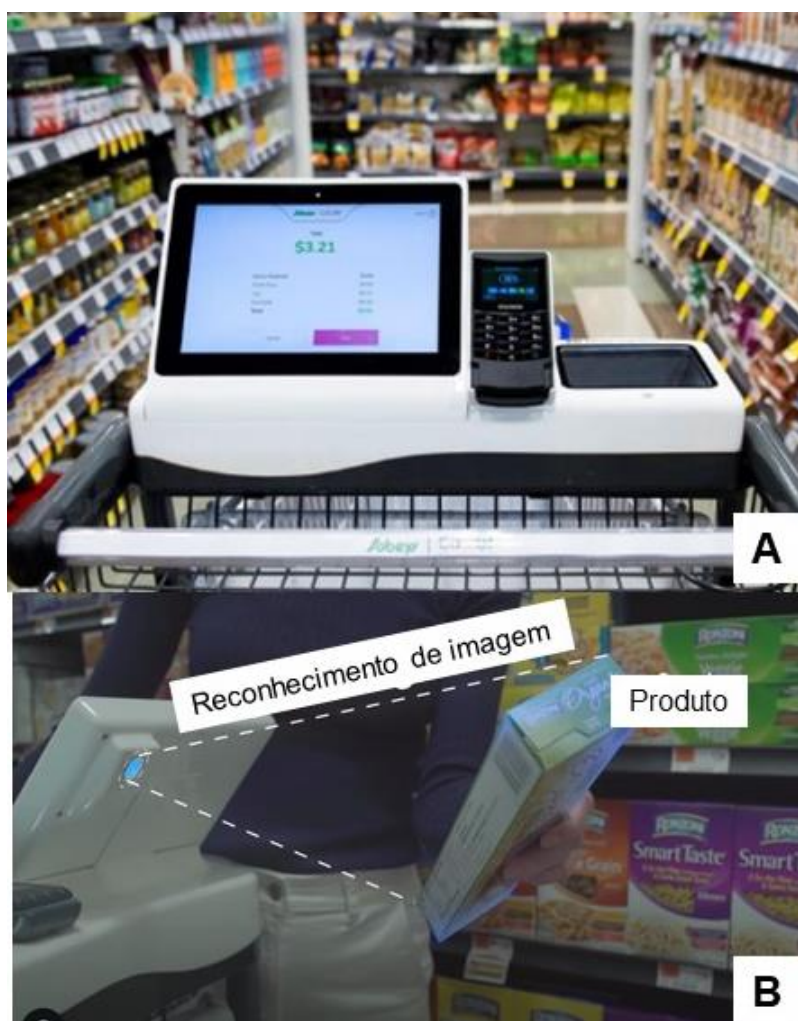
Figura 2 – (a) carrinho de supermercado que está em fase de testes da Caper e (b) demonstração de como o carrinho irá reconhecer o produto através de reconhecimento de imagem
