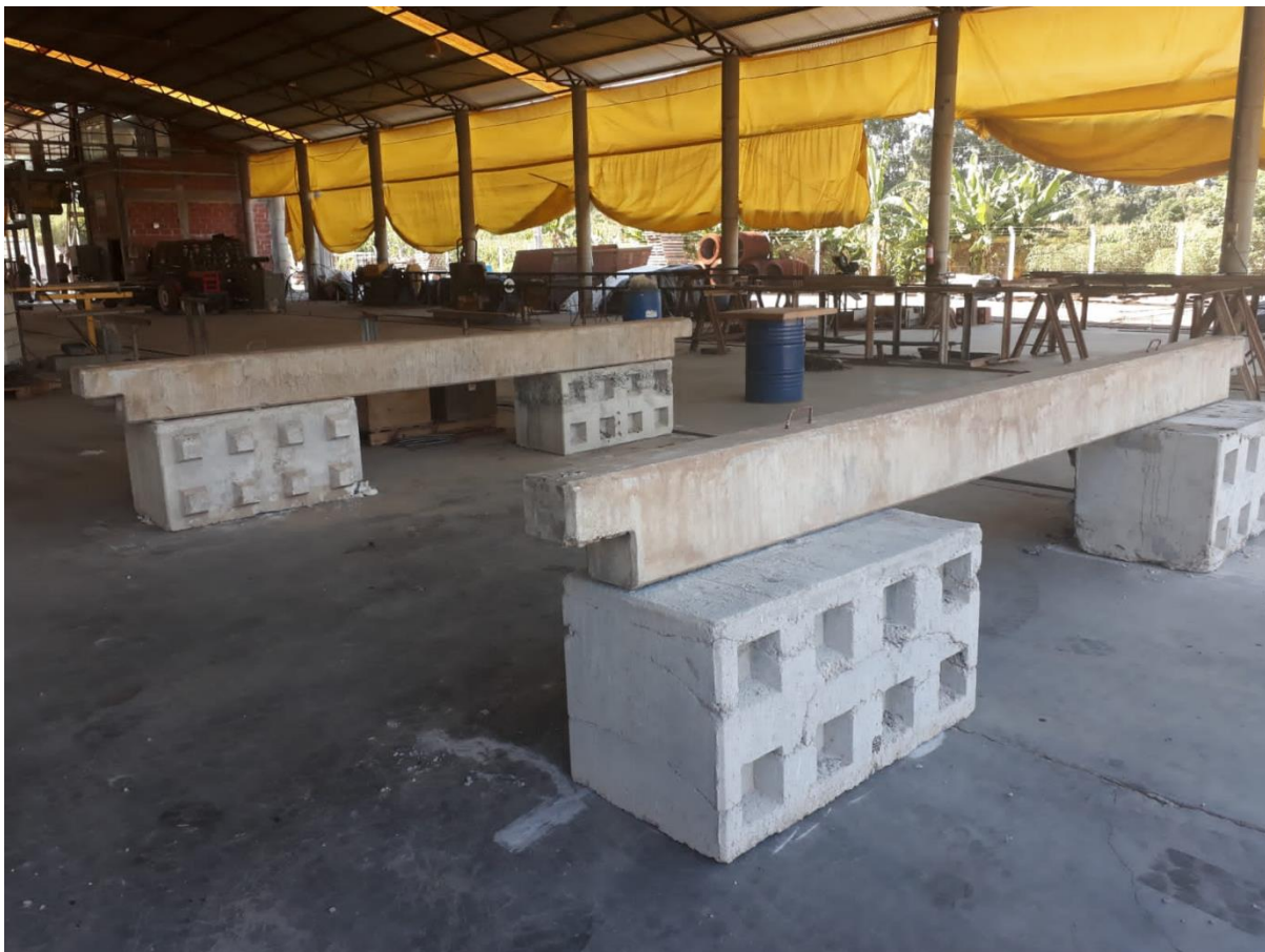
Fotografia 1 – Cavaletes de apoio das lajes
