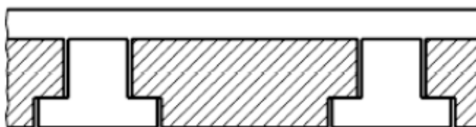
Figura 15 – Piso com vigas autoportantes
