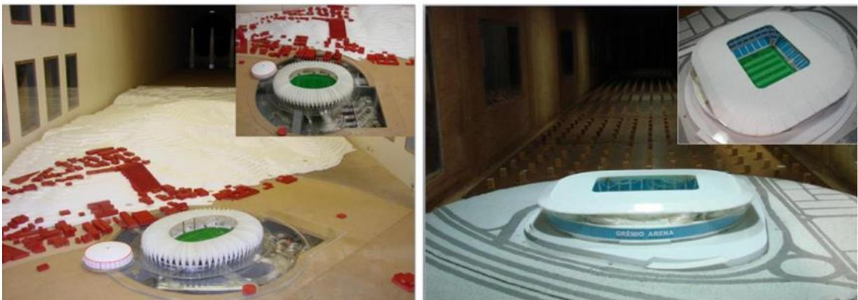
a) Estádio Beira Rio e Arena do Grêmio sendo submetidos a ensaio de túnel de vento
