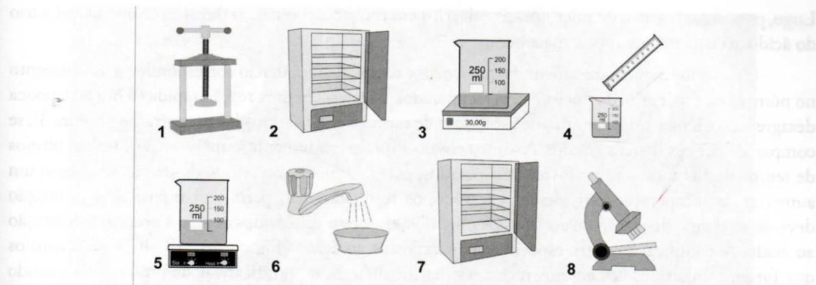
Figura 1. Procedimento para recuperação de microfósseis calcários através da acetólise: fragmentação (1), secagem (2), pesagem (3), adição do ácido acético (4), controle da temperatura em banho de areia (5), lavagem em água corrente (6), secagem (7) e triagem (8).
